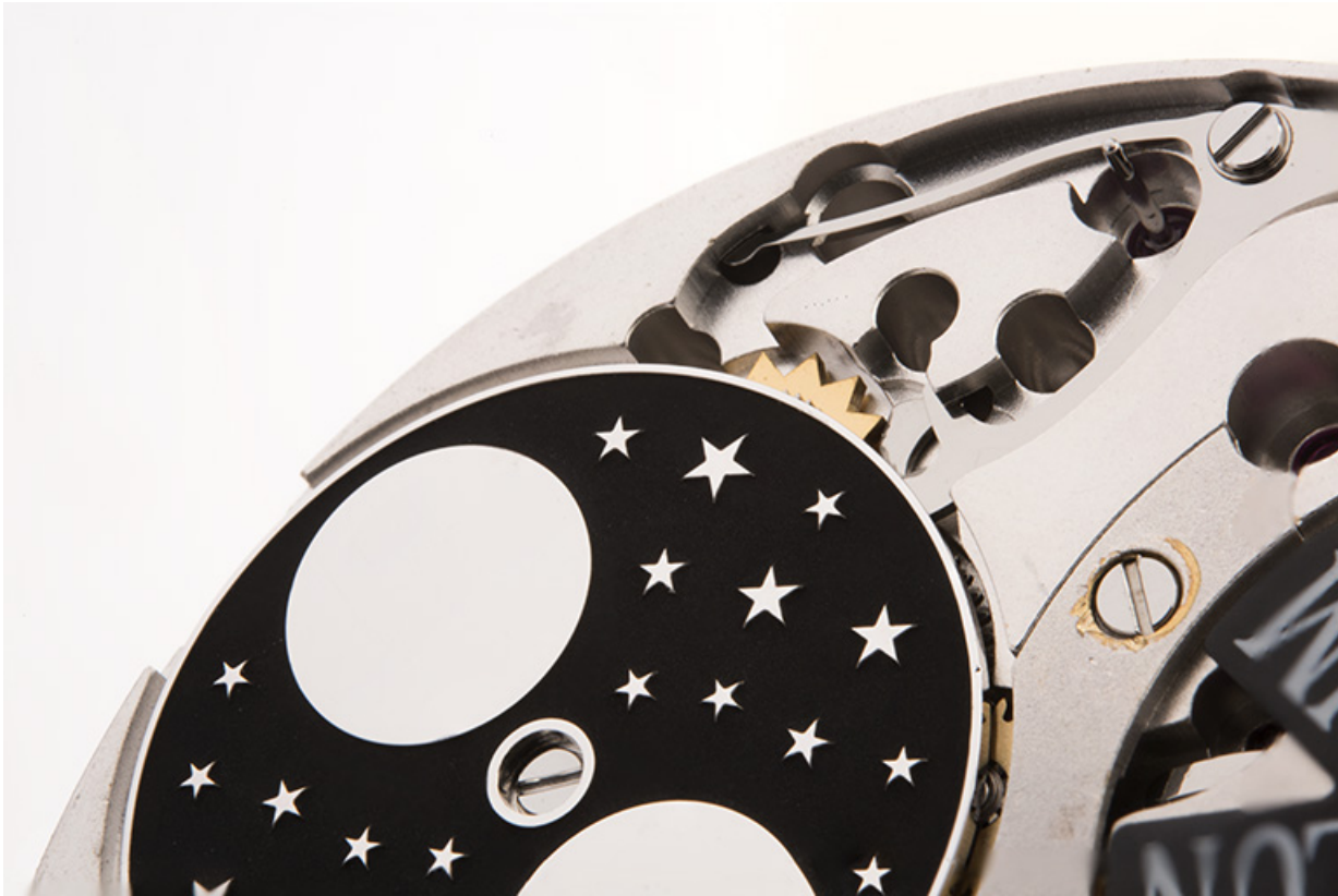
Face côté cadran : détail du disque des phases de lune.
