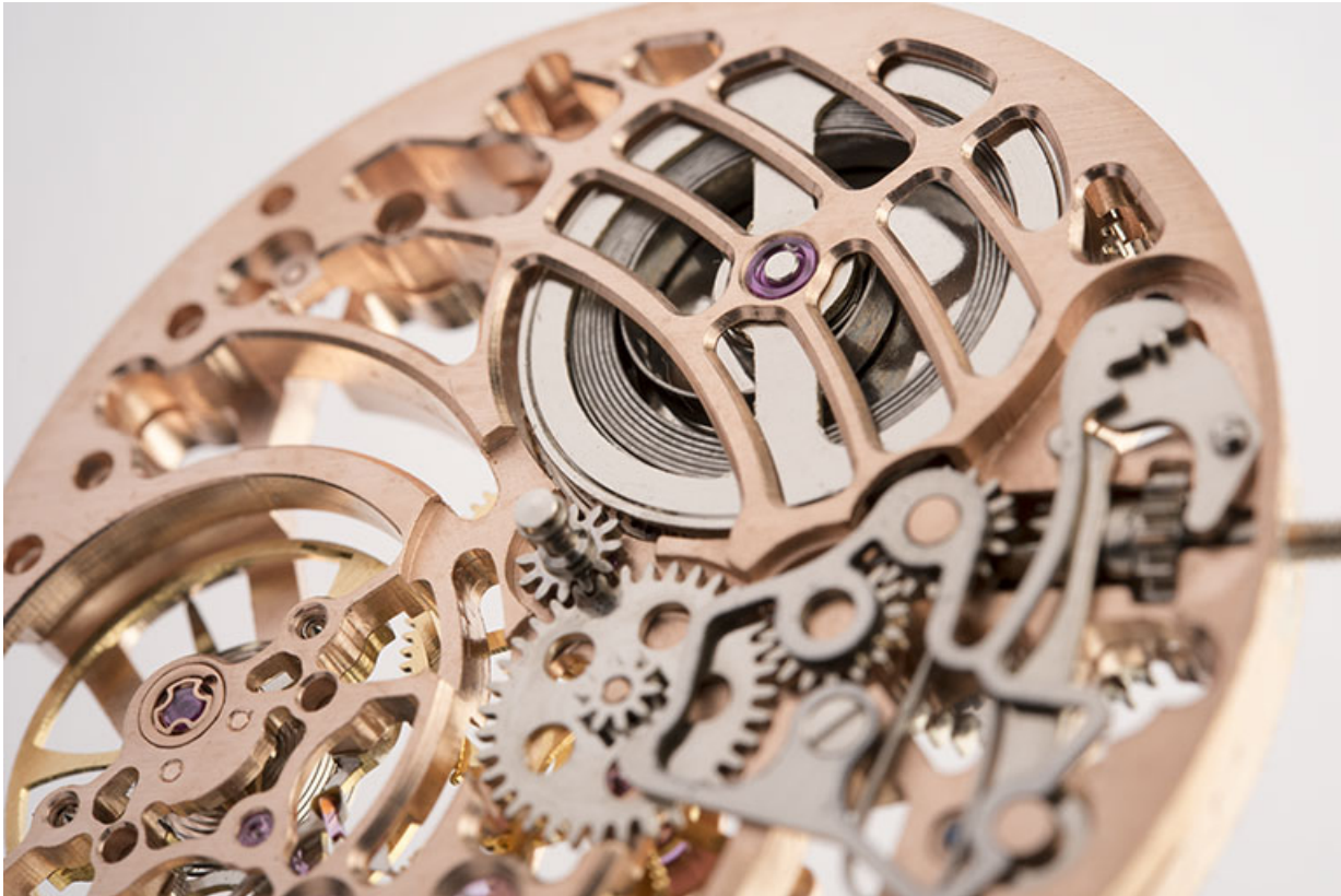
Mouvement rose, détail côté cadran : amortisseur de chocs (à gauche), tirette et pont de barillet (avec ressort moteur). 25, Villers-le-Lac, 4 place Saint-Jean
