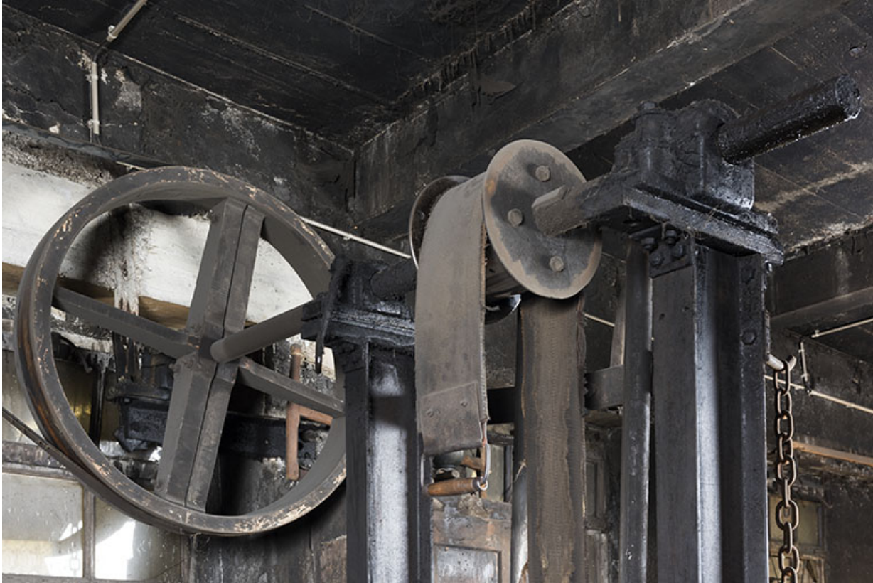
Poulie motrice (à gauche) et tambour métallique sur lequel repose la courroie.
