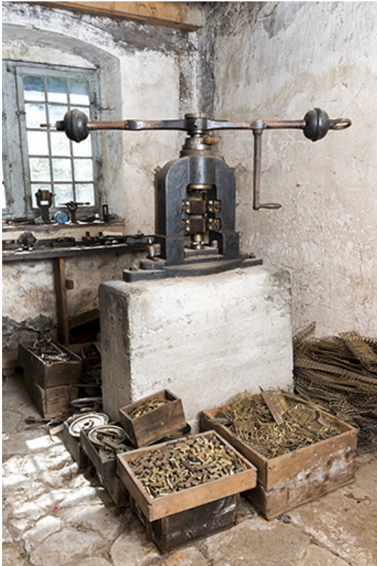
Vue d'ensemble (cadre vertical). Les caisses au premier plan contiennent des pièces découpées (outils à centrer) et des déchets de découpe.
