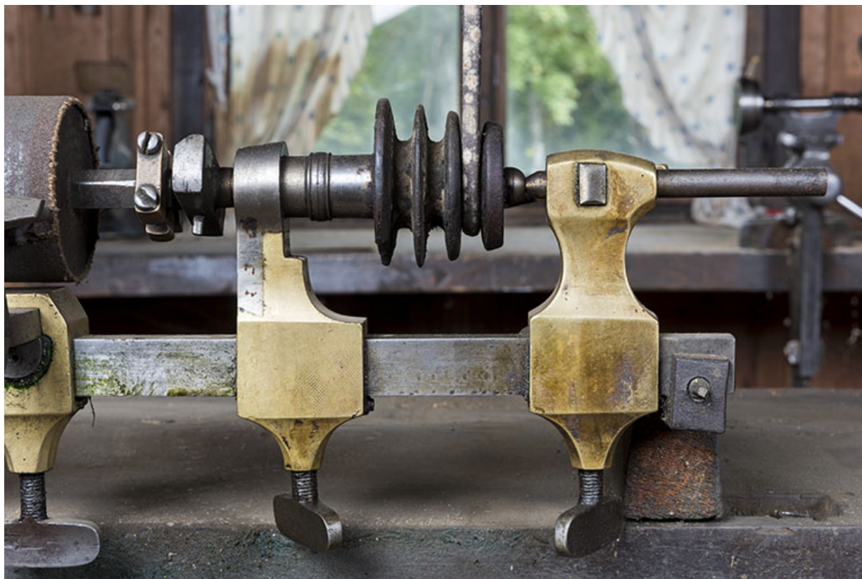
2e tour (machine à polir) : poupée mobiles avec l'arbre moteur et sa poulie. 25, Les Gras
