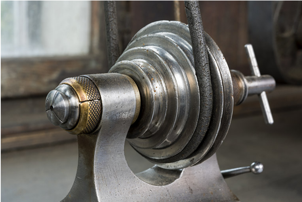
Lunette double avec l'arbre moteur, sa poulie et la pince (à gauche). 25, Les Gras
