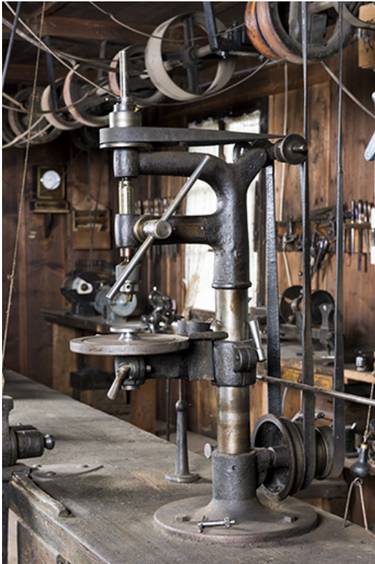
Exemple de disposition : perceuse à colonne des Forges de Vulcain (rangée centrale). La courroie motrice, à l'arrière-plan, entraîne une poulie étagée avec renvoi de mouvement sur la machine.
