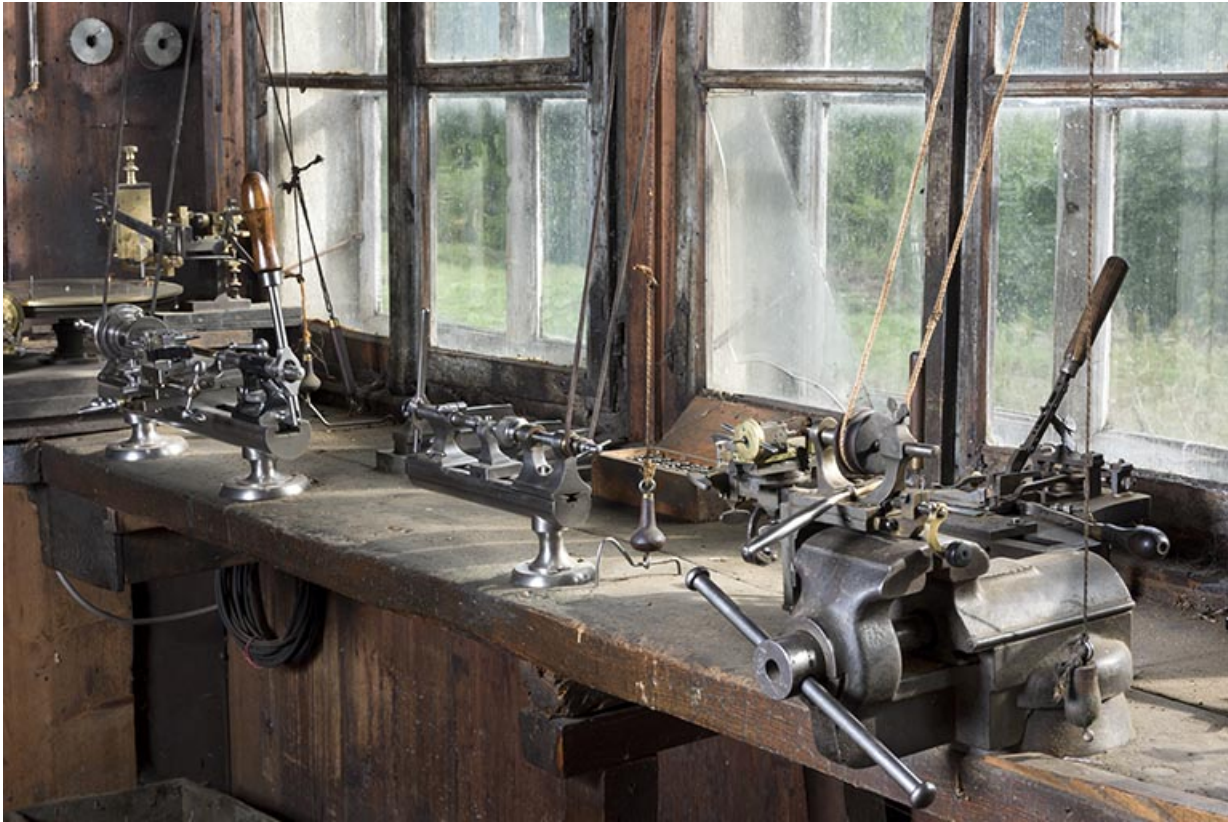
Fabrique d'outillage : tours fixés à l'établi pour un travail "sur la fenêtre". 25, Les Gras
