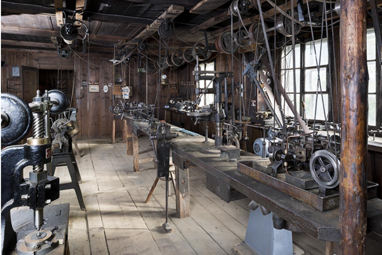
Vue d'ensemble de l'atelier et du système de transmission. 25, Les Gras
