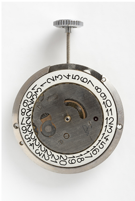
Mouvement Jeambrun PS 33 C : face côté cadran.
