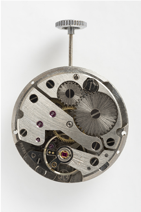
Mouvement Jeambrun PS 33 C : face côté ponts. 25, Villers-le-Lac
