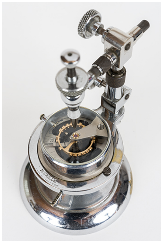
Machine à compter les spiraux (ou machine à régler), par Michel Caille à Villers-le-Lac, 2e quart 20e siècle.
