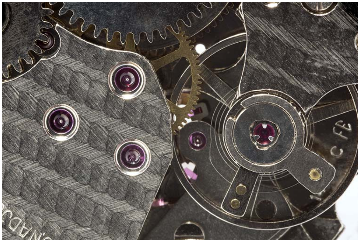
Mouvement FE 140-C : rubis sur le pont de rouage et amortisseur de chocs Epsilon 108. 25, Villers-le-Lac
