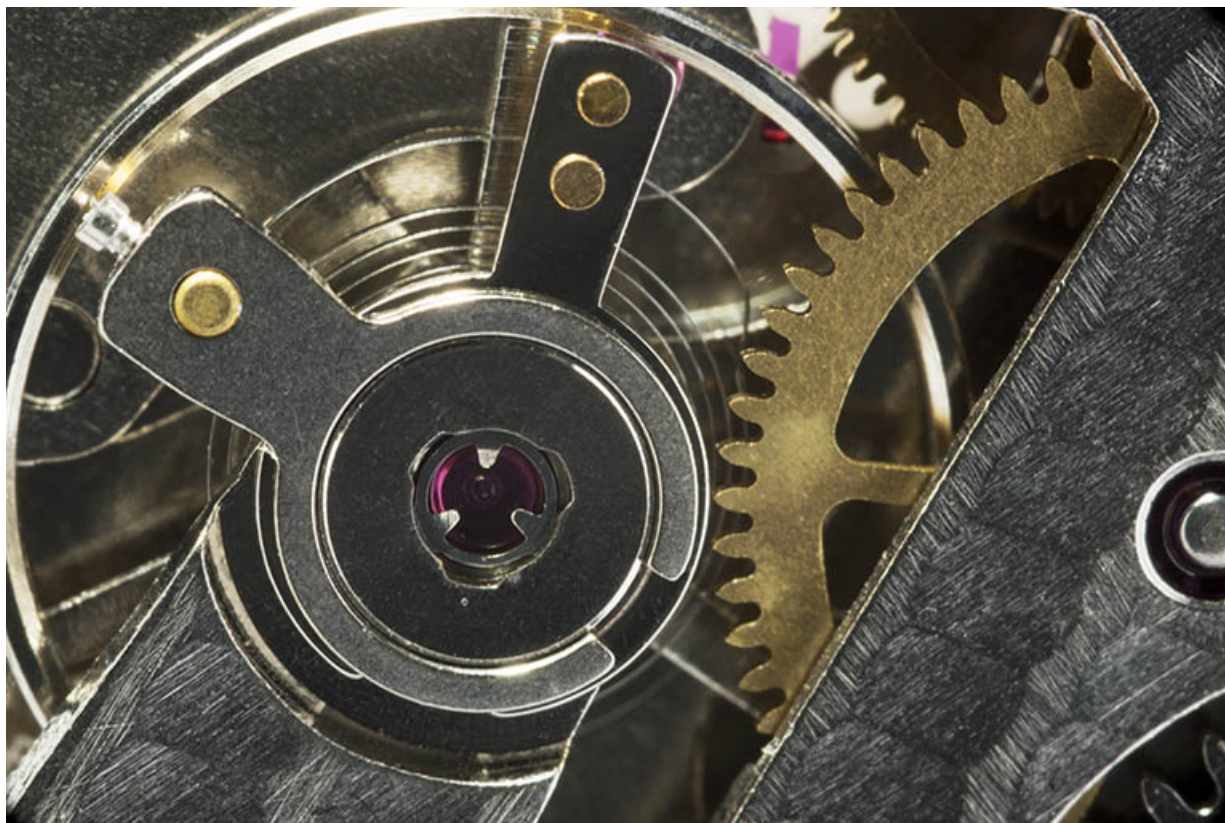
Mouvement FE 233-68-E-21 : l'amortisseur de chocs Epsilon Antichoc 108. 25, Villers-le-Lac
