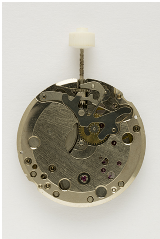
Mouvement France Ebauches FE 233-68-E-21 : face côté cadran. 25, Villers-le-Lac
