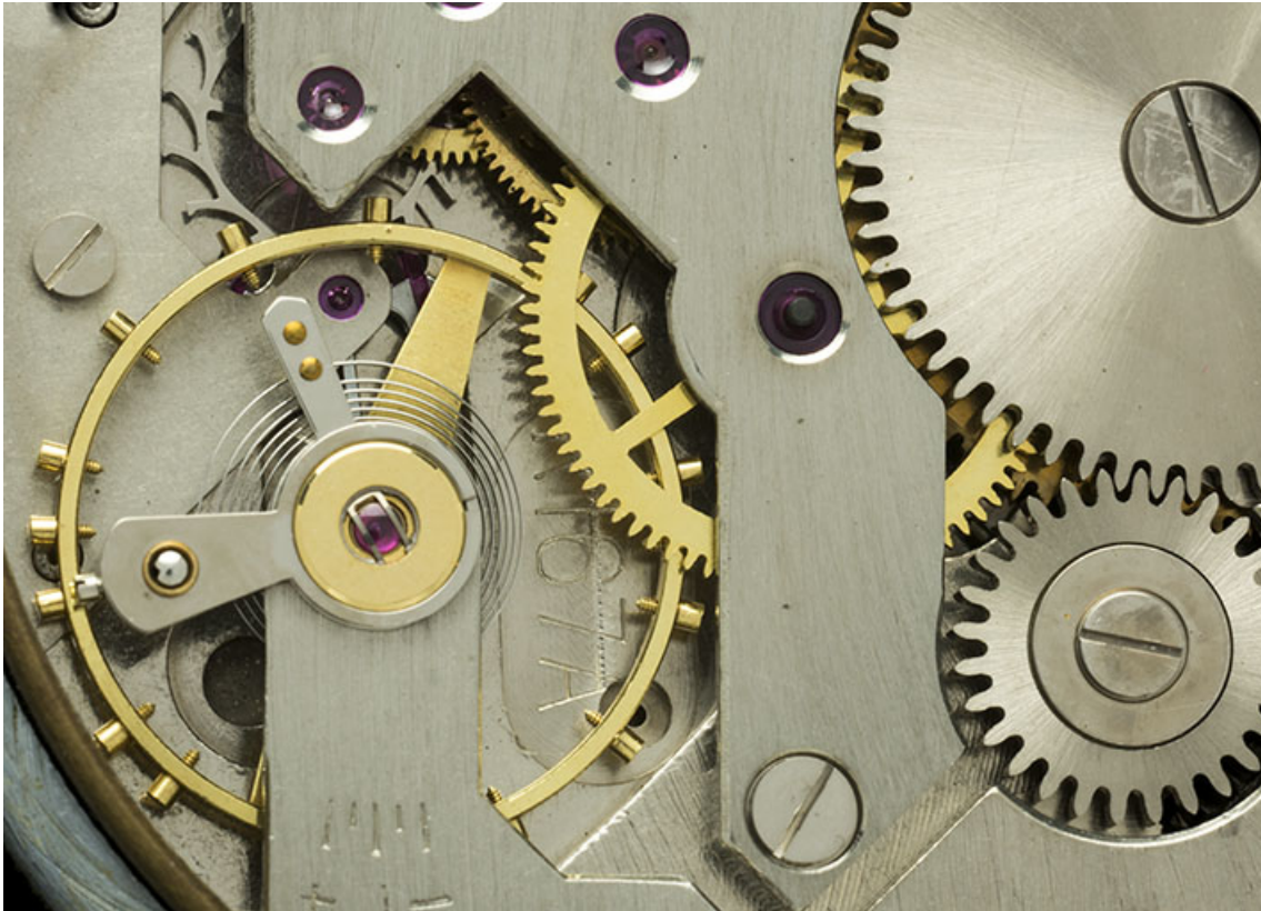
3e montre : détail du mouvement Parrenin HP 40. 25, Villers-le-Lac
