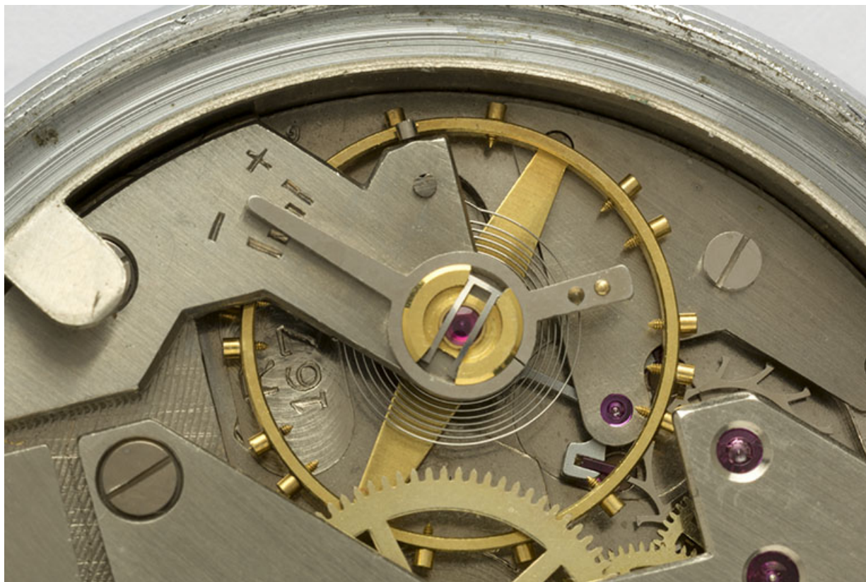
4e montre, mouvement Parrenin HP 40 : numéro de modèle Lip (R 167) gravé près du pont de balancier. Mal effacée, la pointe supérieure du logotype Parrenin est visible à gauche, près d'une vis du balancier.
