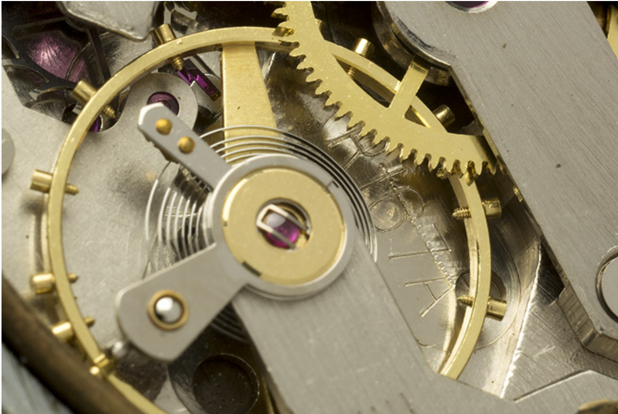
3e montre, mouvement Parrenin HP 40 : numéro de modèle Lip (R 167 A) gravé près du pont de balancier. 25, Villers-le-Lac
