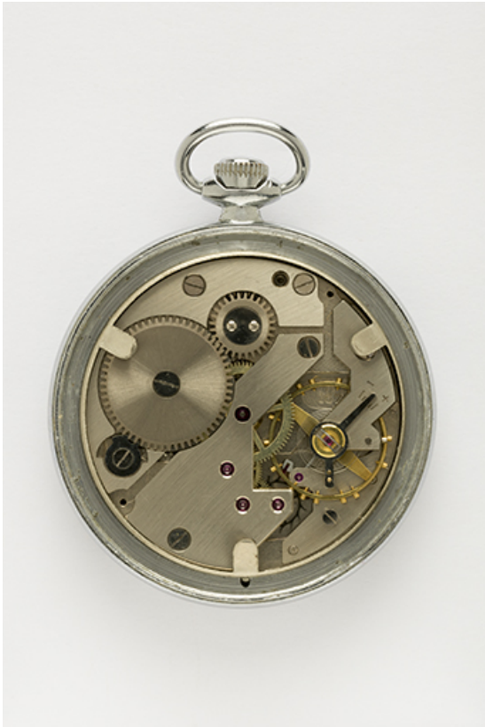
4e montre : mouvement Parrenin HP 40.
