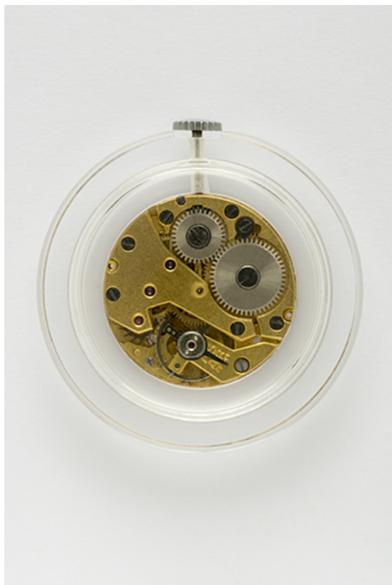
Mouvement Parrenin HP 87 : face côté ponts.
