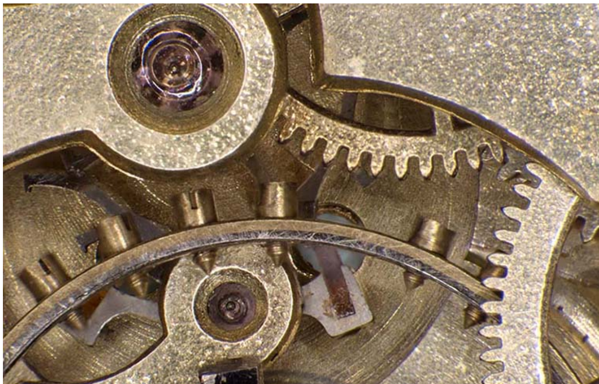
Mouvement, détails : contre-pivot en rubis, balancier à vis, ancre (avec ses palettes en rubis) et roue d'ancre. 25, Villers-le-Lac
