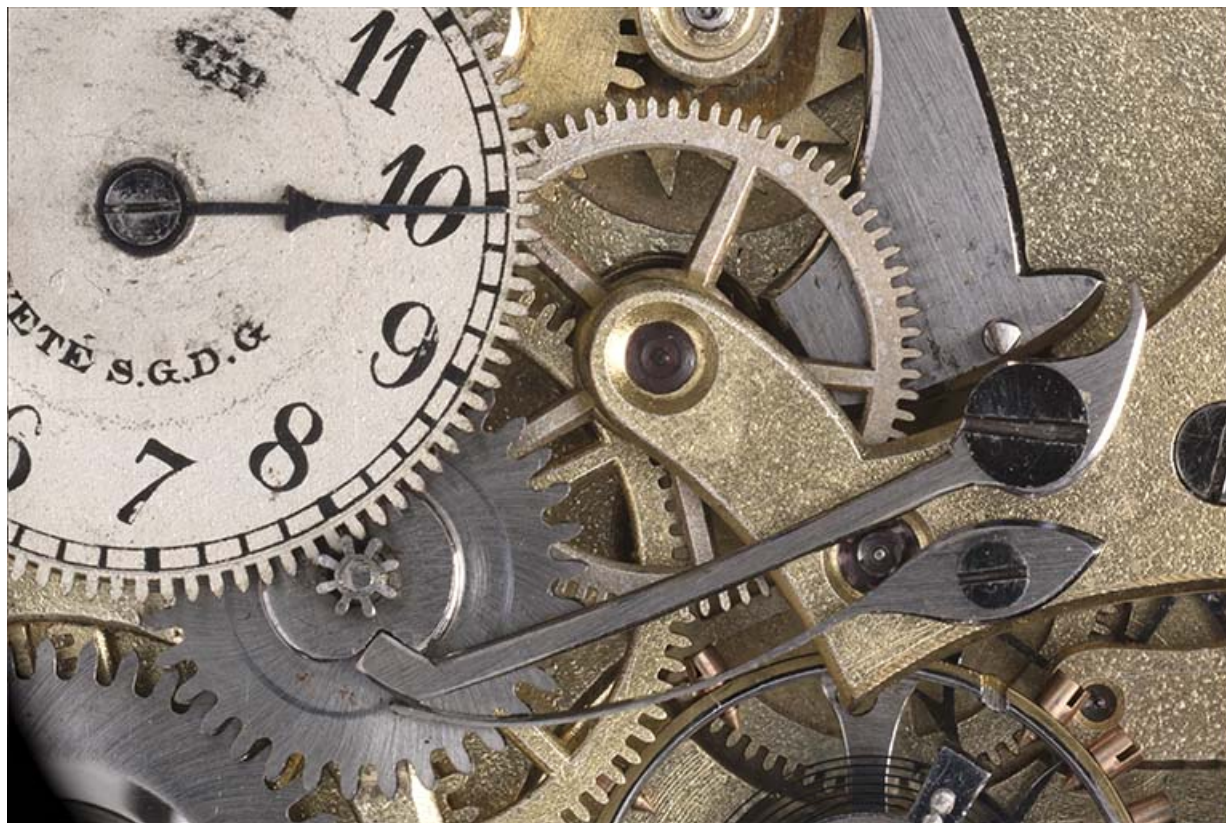
Mouvement : mécanisme du réveil.
