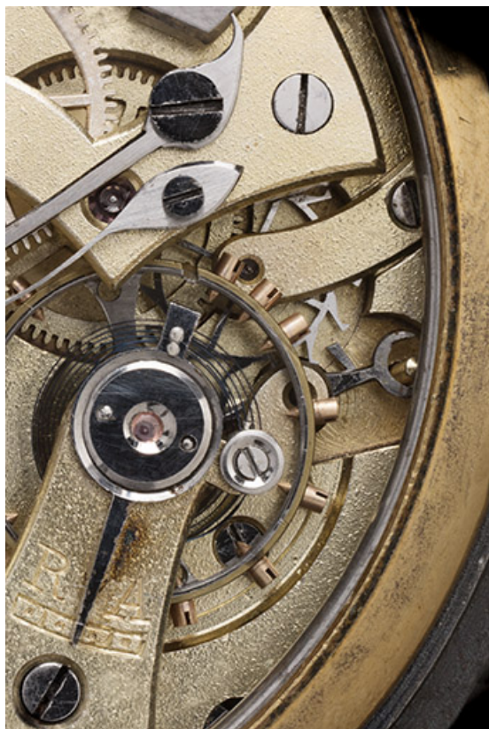
Mouvement : balancier, ancre et roue d'ancre. 25, Villers-le-Lac
