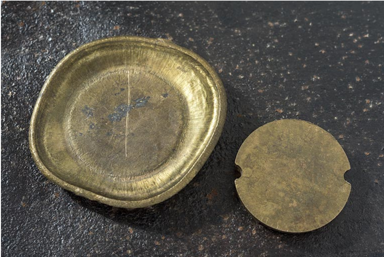
Ebauche obtenue par frappe à chaud (verso).
