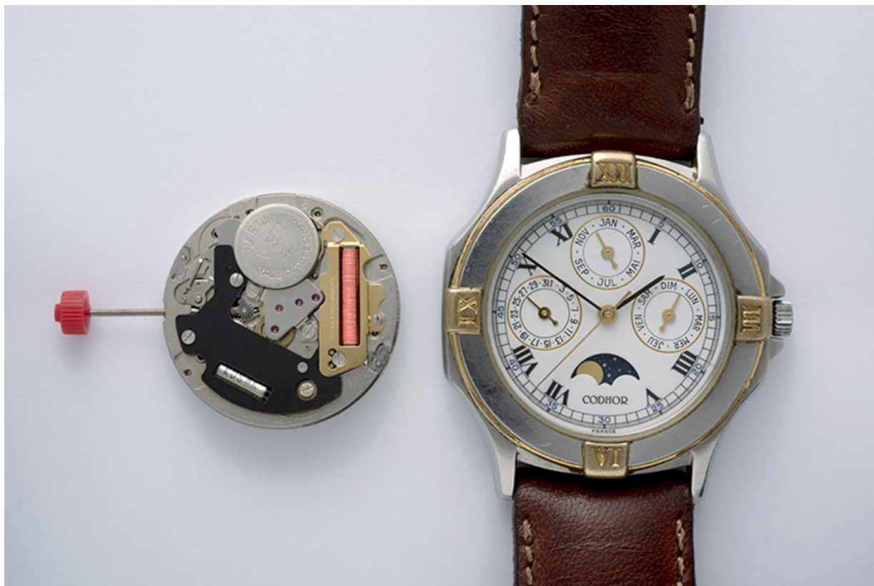
La montre côté cadran à côté d'un mouvement FE 11500, vu côté ponts. 25, Maïche
