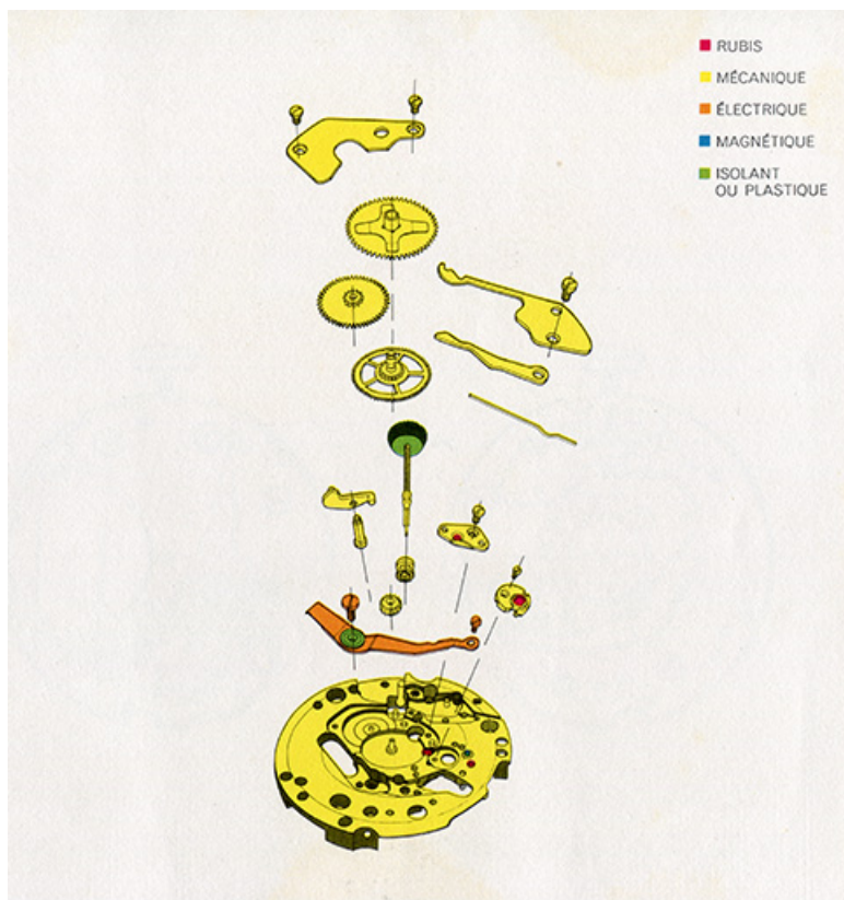
Lip Electronic R 148 [présentation sous forme d'éclaté : côté cadran], années 1960. 25, Maîche
