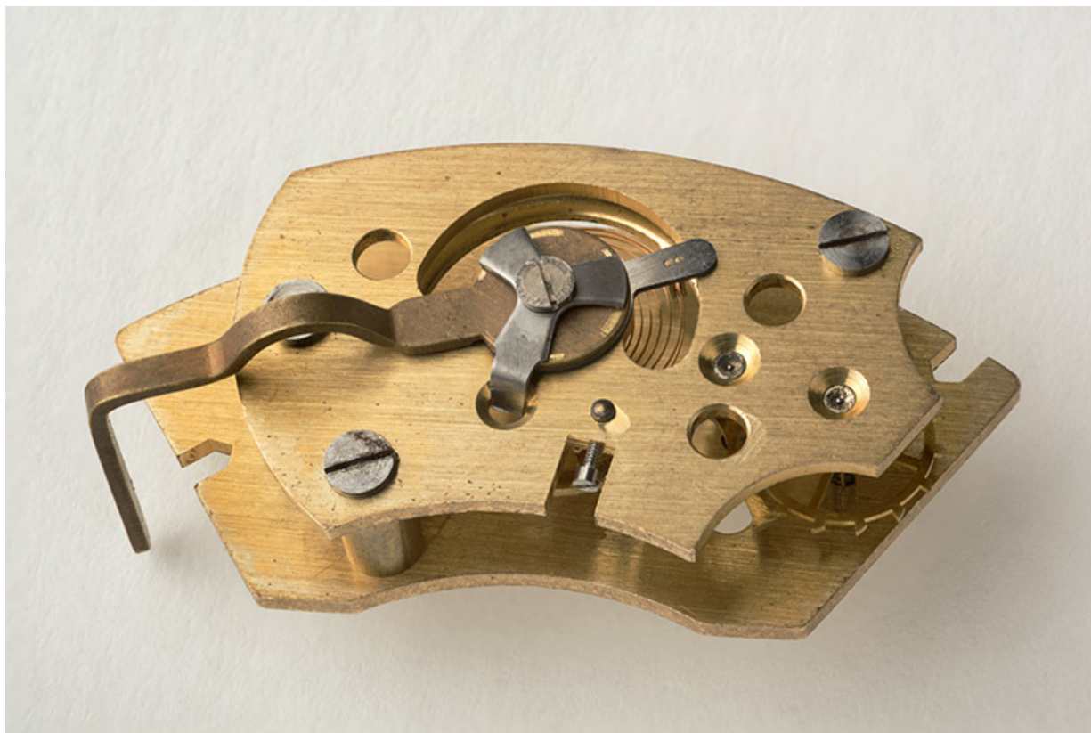
Porte-échappement à chevilles Jeambrun Appareillages, à Maïche, 2e moitié 20e siècle. 25, Maïche
