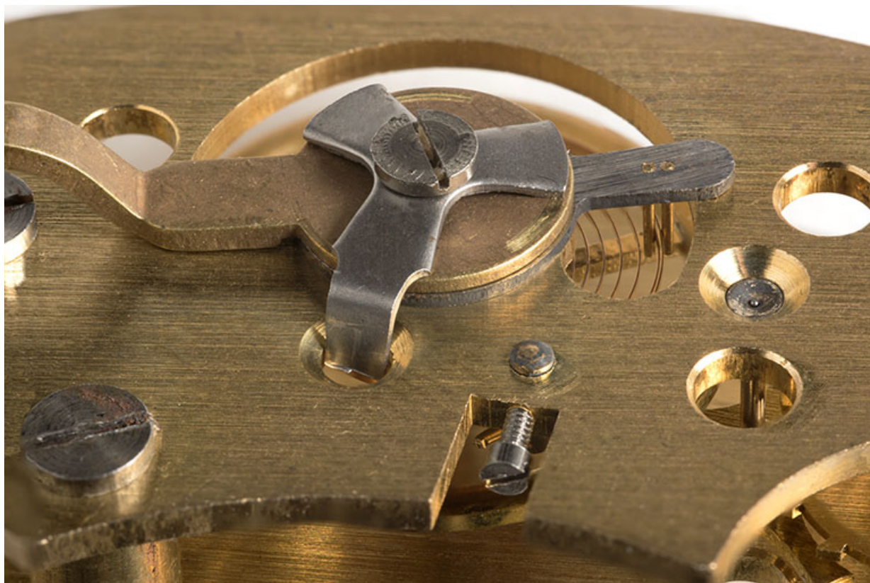
Système de réglage de l'avance/retard : raquette permettant de modifier la longueur active du spiral. 25, Maîche
