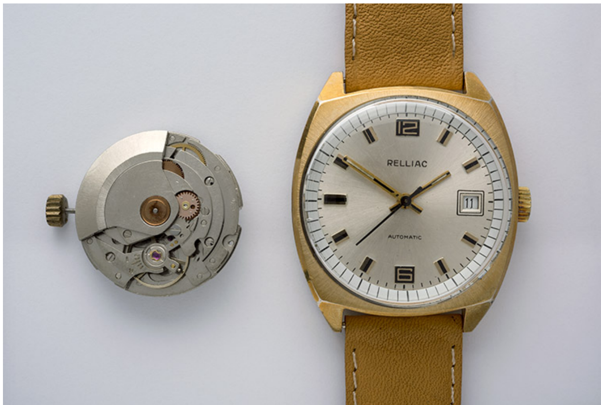
Montre-bracelet automatique Relliac (à côté d'un mouvement France Ebauches FE 4611), à Maîche, vers 1980. 25, Maîche
