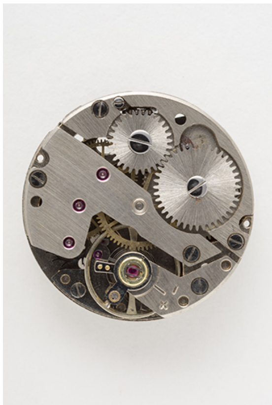
Mouvement Cupillard 233-60, vu côté ponts. 25, Maïche
