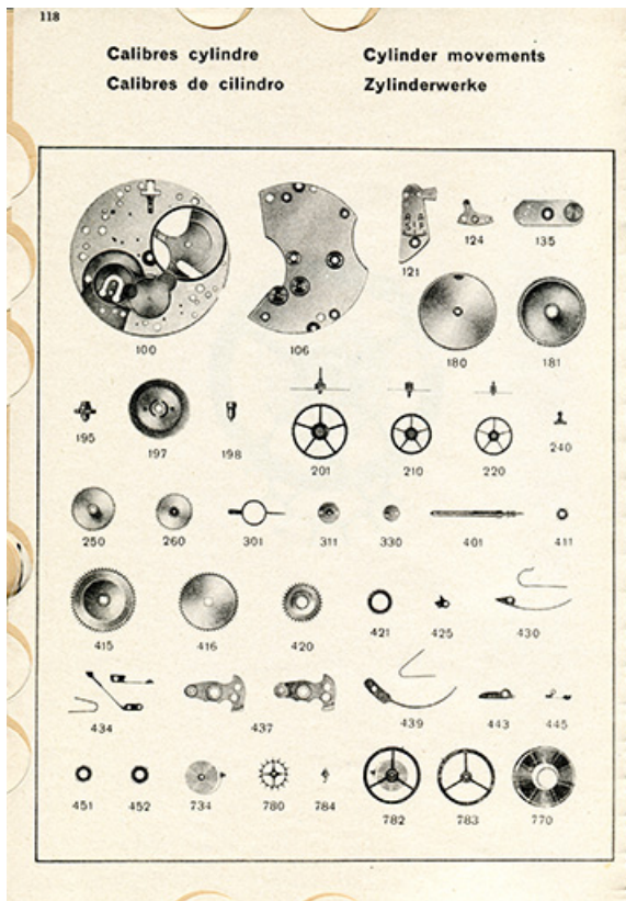
Calibres cylindre [dessin des fournitures composant un calibre cylindre], 1955. 25, Charquemont, 12 Rue Neuve
