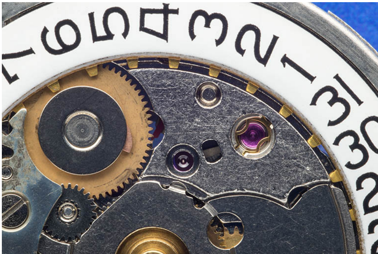
Détail de la face côté cadran : barillet et sa roue dentée à gauche, amortisseur de chocs Incabloc à droite.. 25, Charquemont, 12 Rue Neuve
