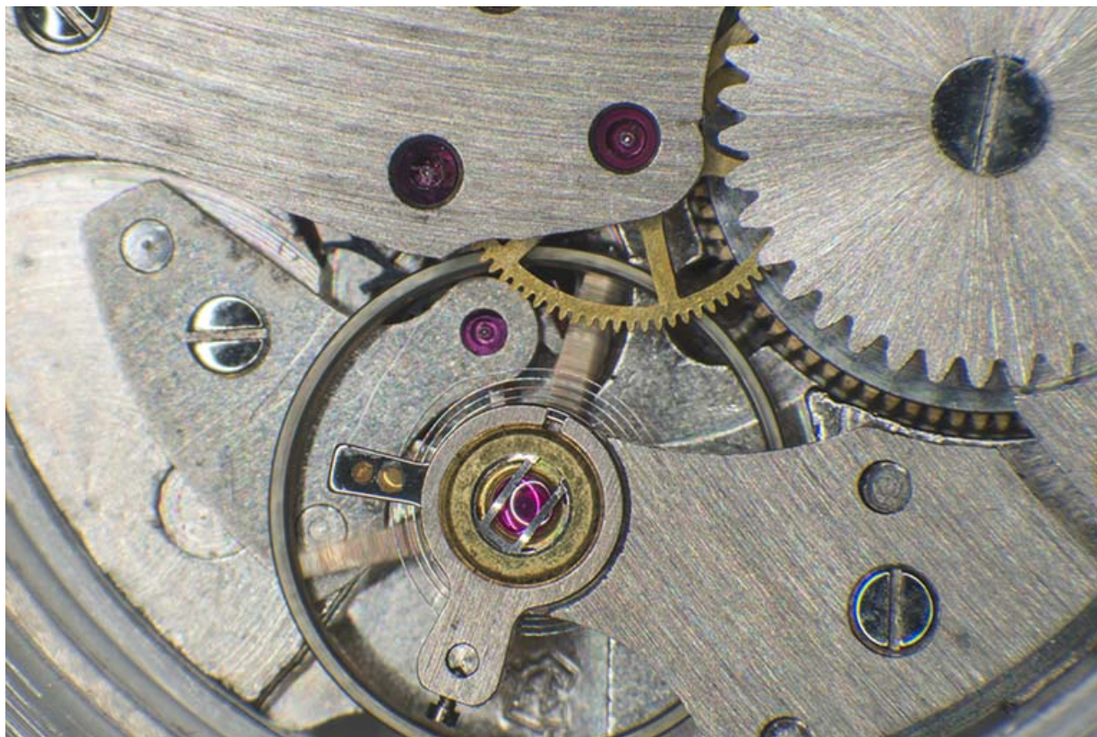
Mouvement de montre France Ebauches FE 140 : détail du balancier-spiral (surmontant l'échappement à ancre) muni de son système antichoc à rubis synthétique.
