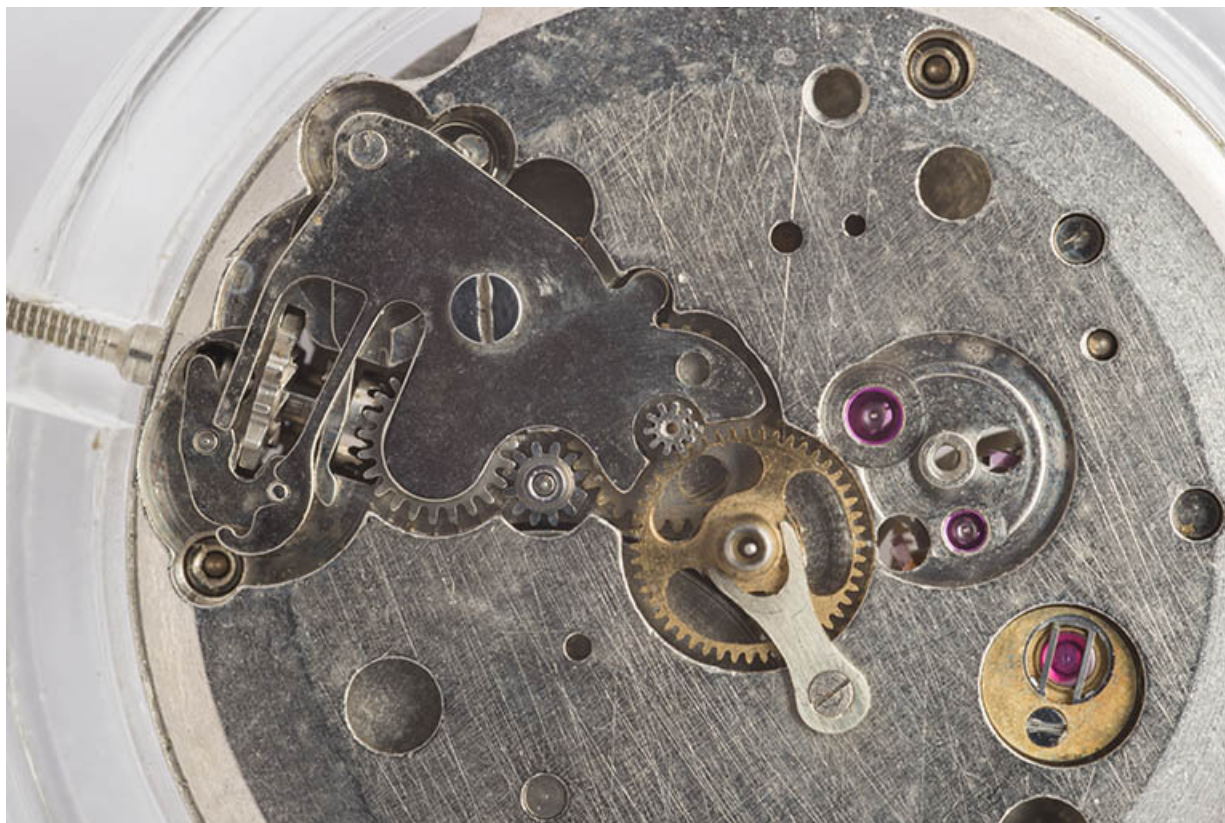
Mécanisme du remontoir (côté cadran). A droite, l'amortisseur de chocs.
