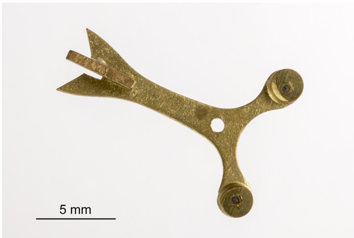
Echappement à chevilles : ancre (2e face).
