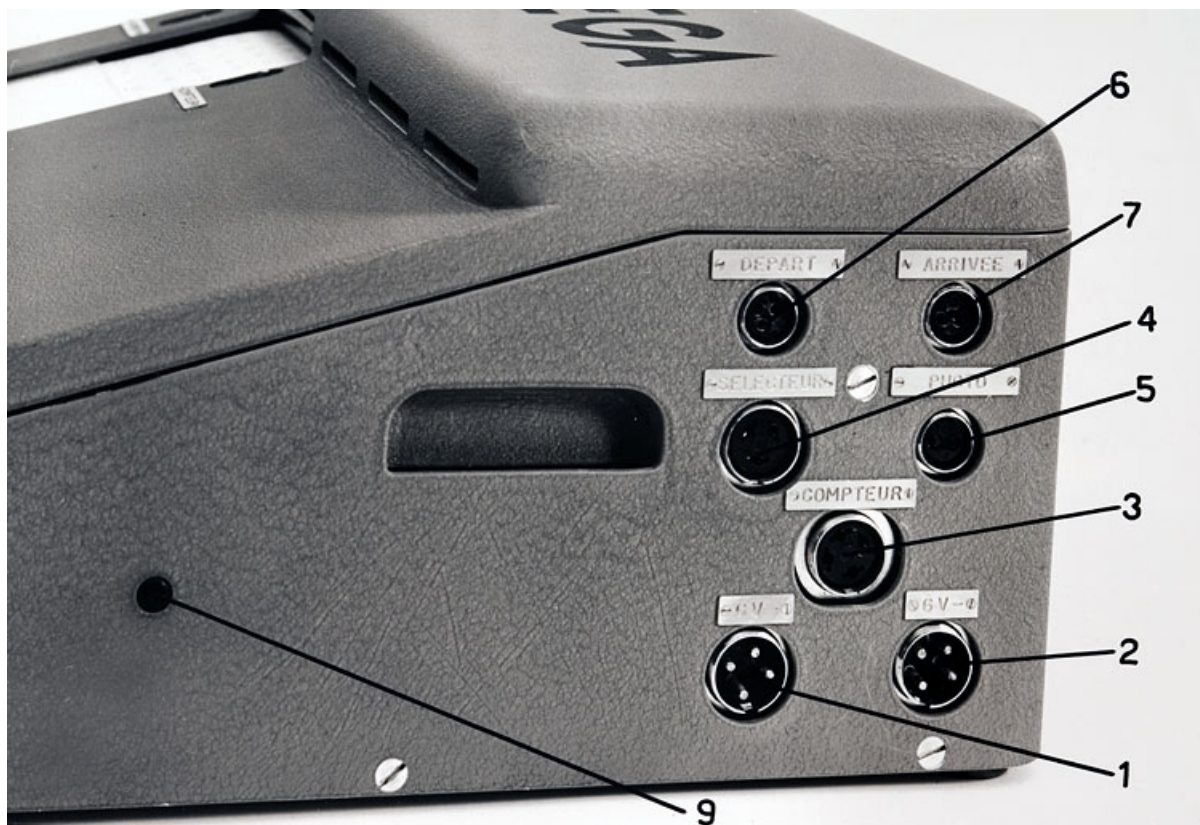
[Chronographe Oméga Time Recorder : points de branchement sur le côté], 1954.
