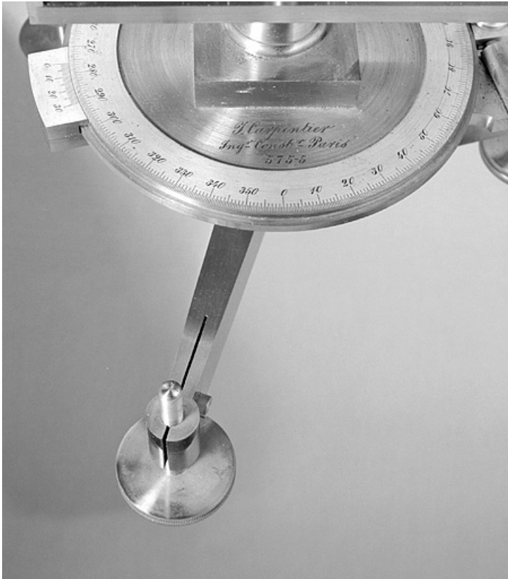
Vue de détail du limbe gradué, du vernier et de l'inscription concernant le fabricant.
