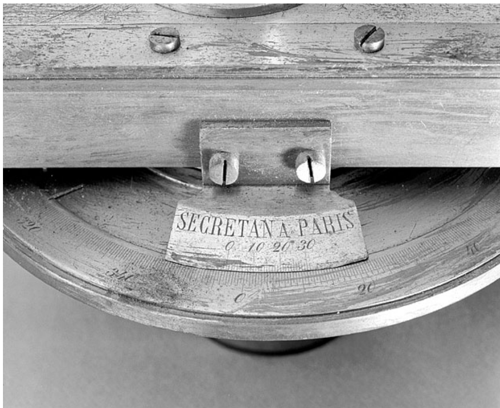
Détail du cercle et de la vis tangente gradués, portant le nom du fabricant.
