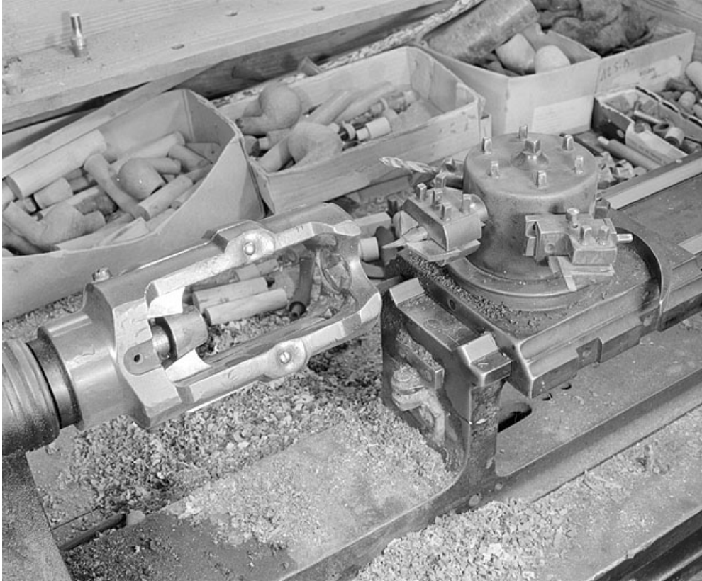
Tour (atelier de finissage). Les mâchoires et le revolver alignés.
