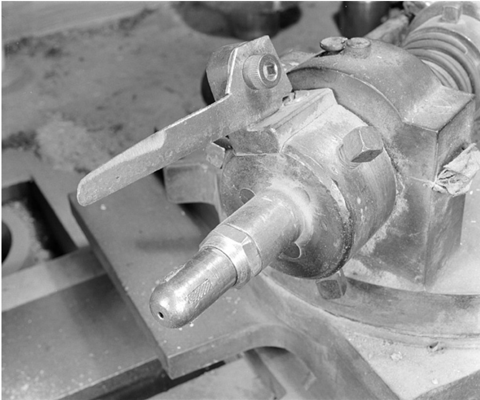
Détail du système de fixation du fourneau par l'intérieur du foyer (arrondisseur de l'atelier de finissage). 25, Baume-les-Dames rue des Pipes, lieudit : Gondé
