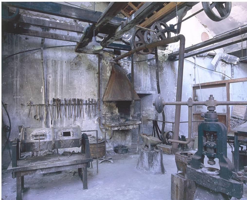
Atelier de mécanique. Départ de la transmission et poulie maîtresse (au fond). 25, Baume-les-Dames rue des Pipes, lieudit : Gondé
