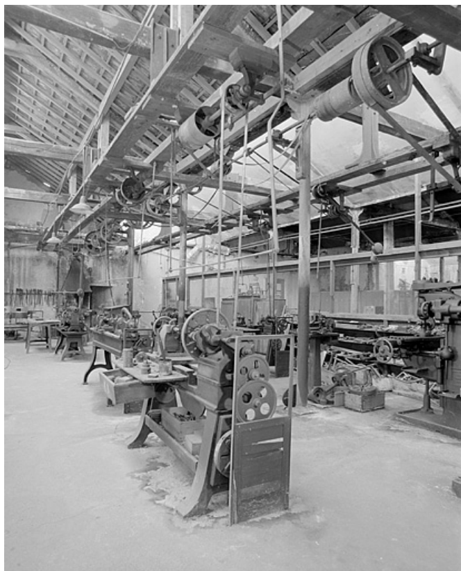
Atelier de mécanique. Distribution par courroies verticales.
