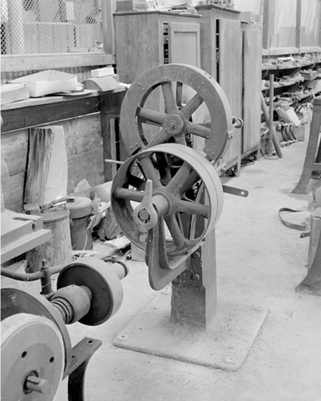
Détail des poulies de transmission.
