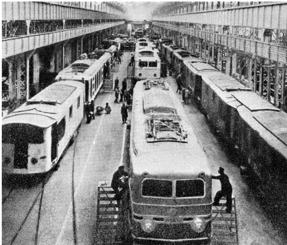
Hall de montage des locomotives électriques.
