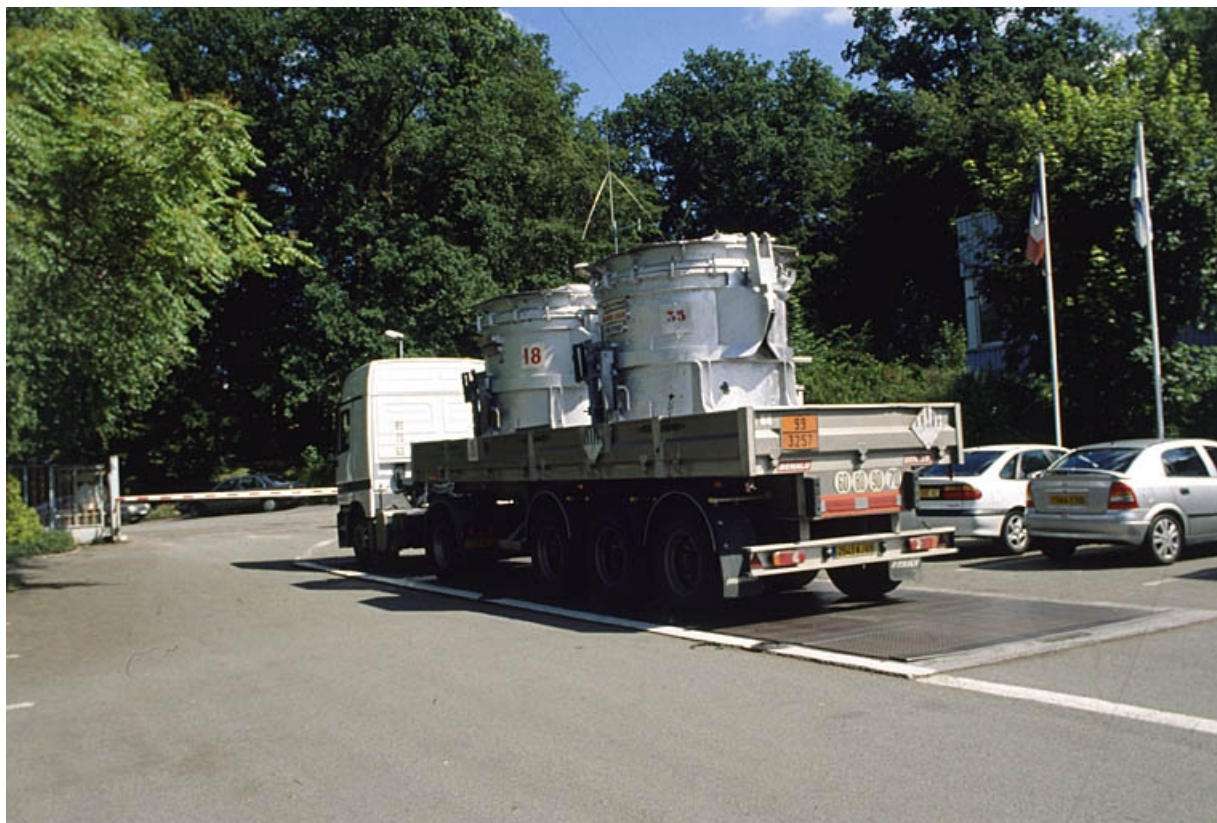
Camion chargé de deux poches d'aluminium liquide.
