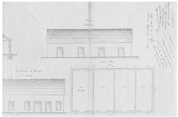
Jean Schmitt, industriel à Thann. Demande en autorisation d'établir une usine de teinture, blanchiment et impression sur écheveaux [plan et élévation des séchoirs].
