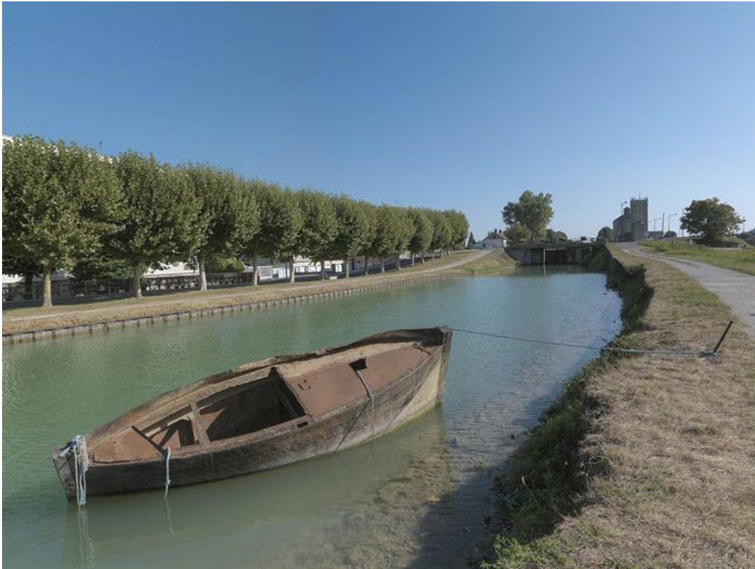
Bateau-écluse ou bateau-porte amarré dans le bief 114-115, en aval du pont sur l'écluse 113. 89, Migennes, lieudit : bief 114-115 du versant Yonne
