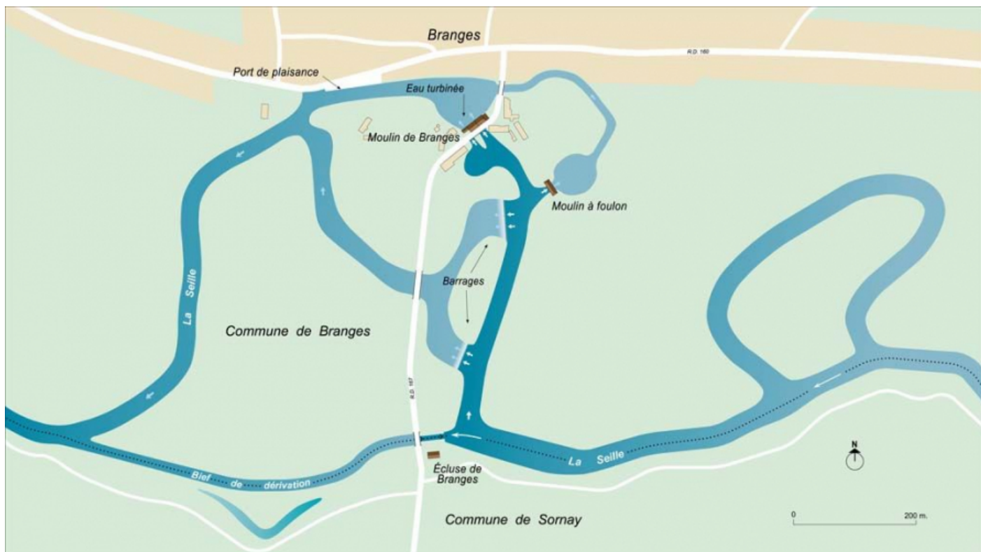
Plan schématique du site de l'écluse de Branges, des barrages et des moulins.
