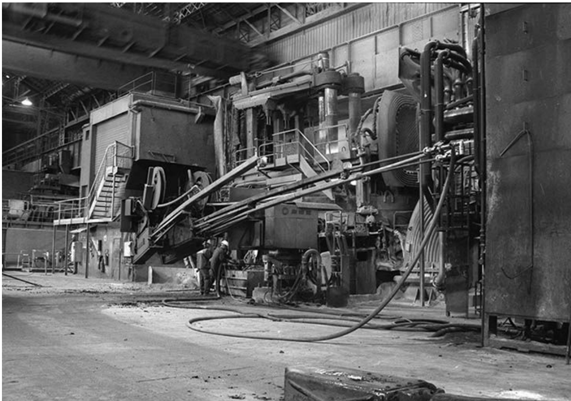
Le four électrique de 100 tonnes en activité.
