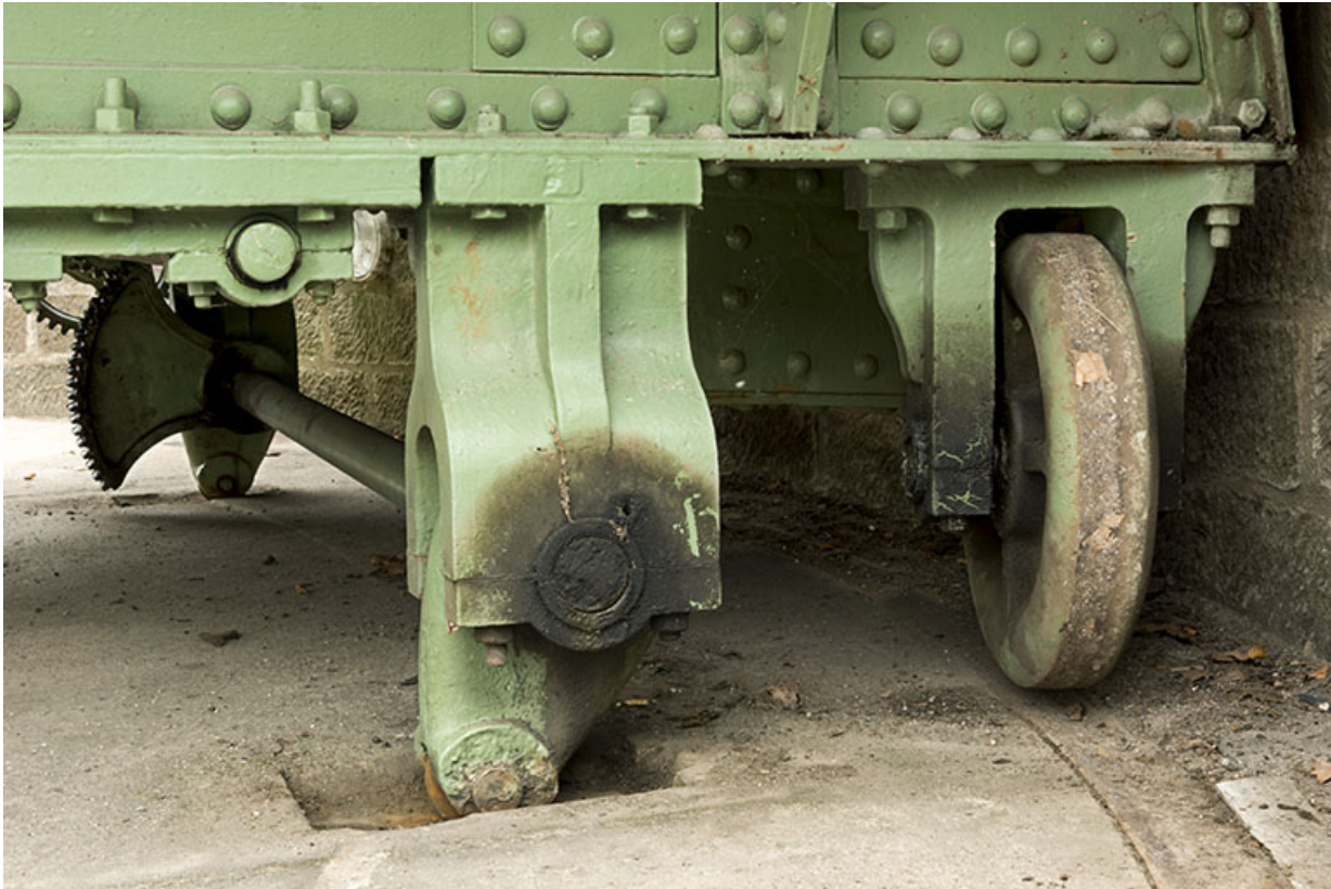
Système de calage, axe et engrenages.
