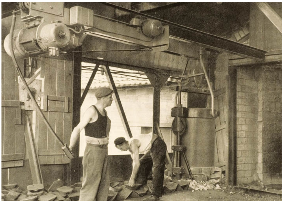
Chargement automatique des cubilots par bennes à fond ouvrant.
