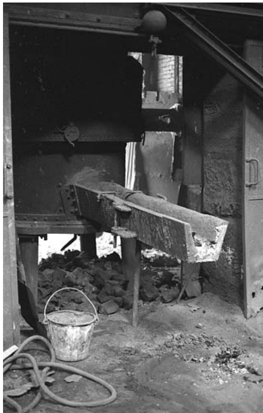
Grand cubilot. Rigole de coulée.
