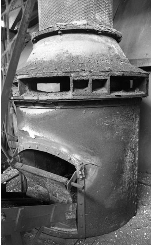
Gueulard (partie supérieure) du grand cubilot (5 tonnes). 70, Arc-lès-Gray, 5 rue de Verdun
