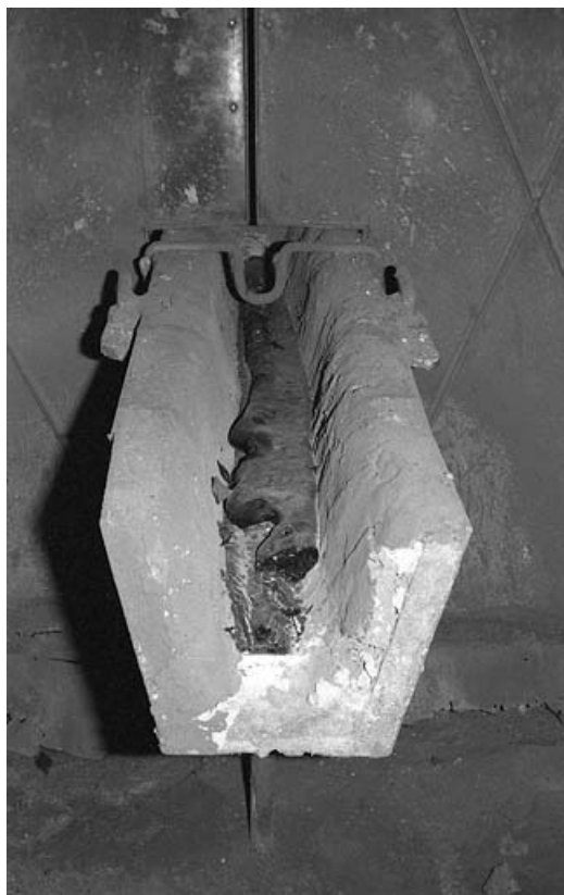
Grand cubilot. Détail de la rigole de coulée.
