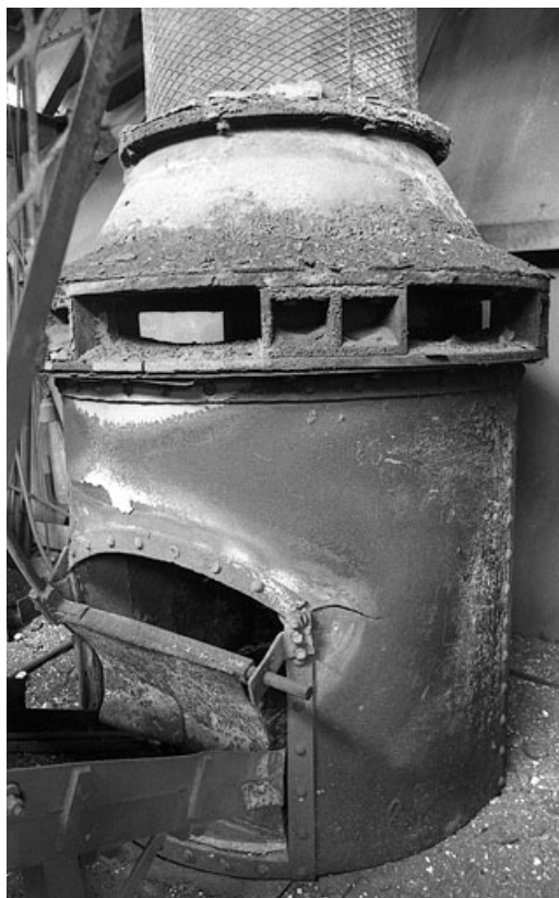
Gueulard (partie supérieure) du grand cubilot (5 tonnes). 70, Arc-lès-Gray, 5 rue de Verdun
