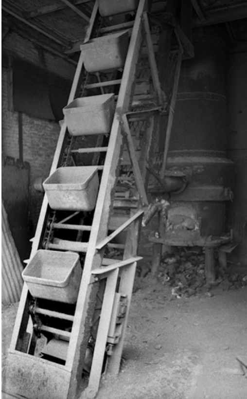
Chargeur à godets du grand cubilot (5 tonnes).
