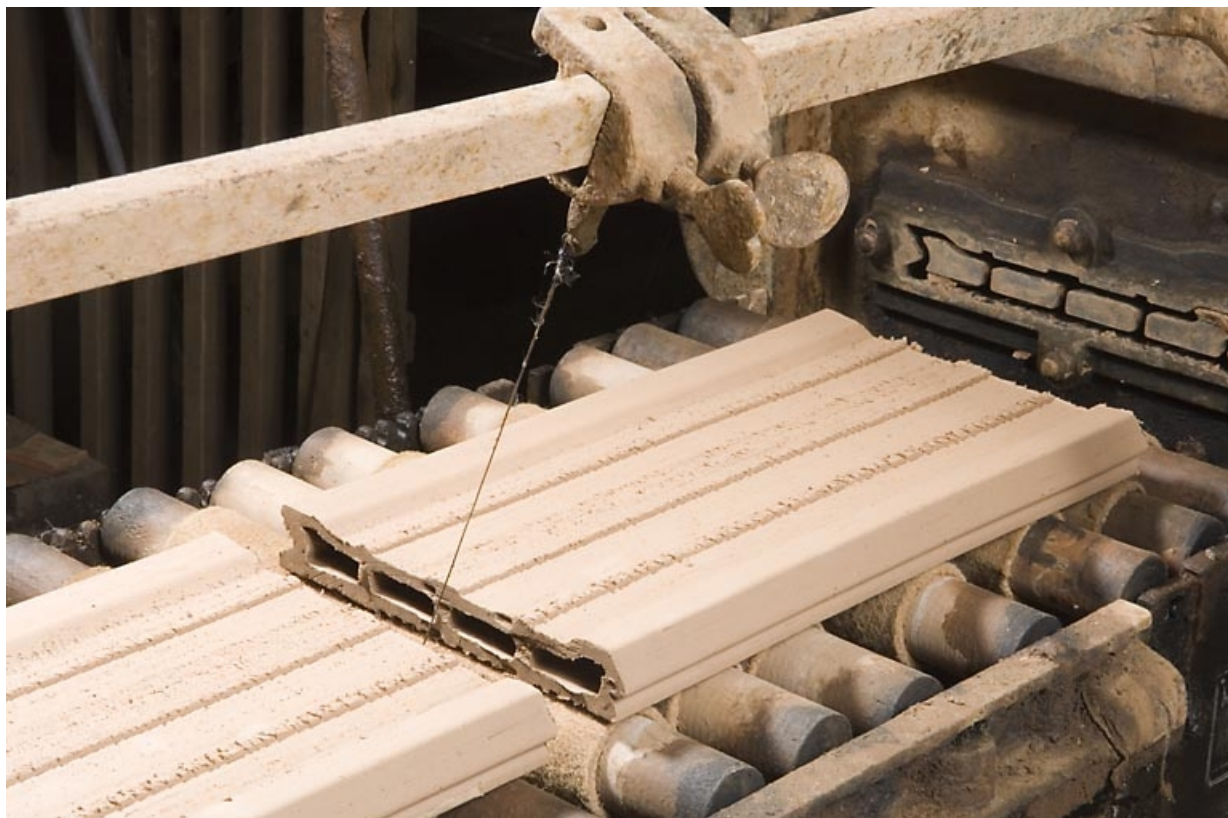
Chariot de la mouleuse-étireuse. Découpage par fil. 70, Montureux-et-Prantigny R.N. 70, lieudit : la Tuilerie
