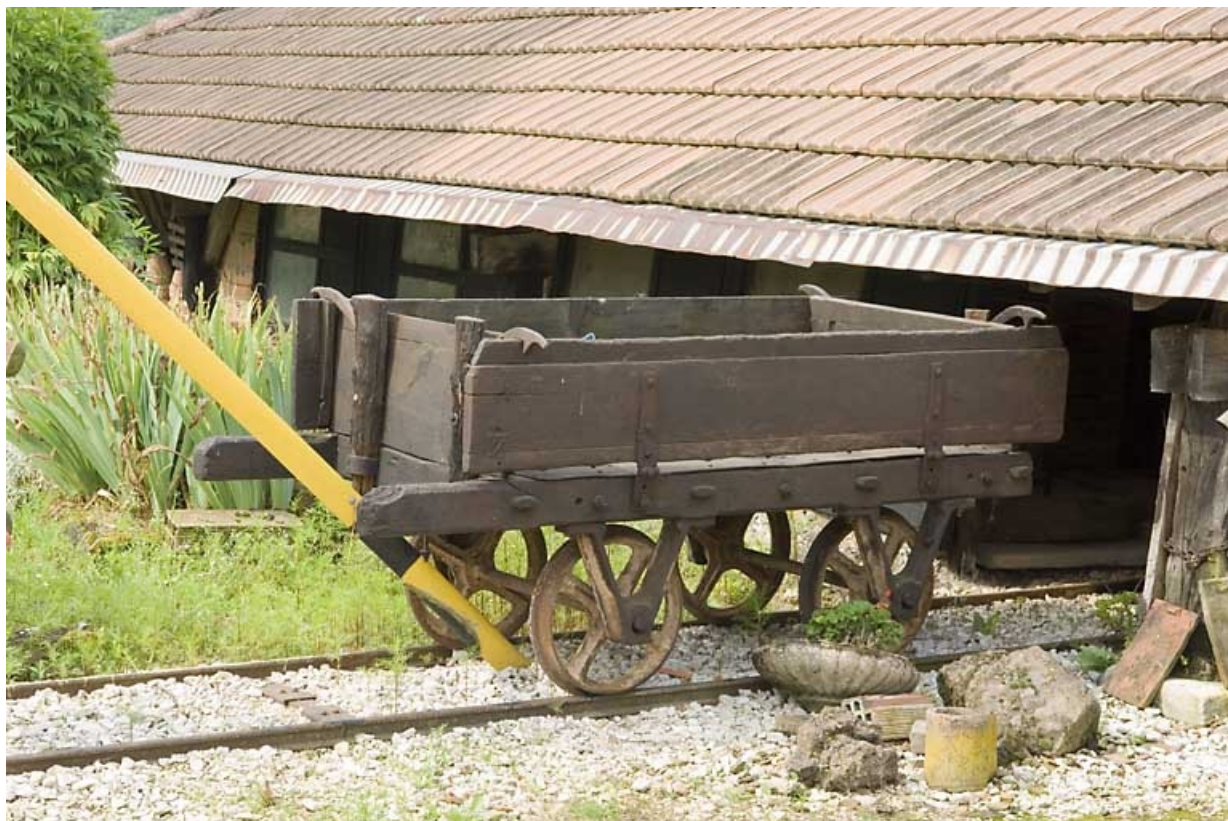
Wagonnet en bois (transport de la terre).
