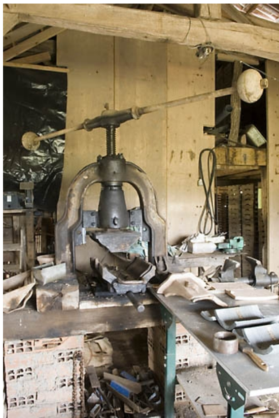
Presse à balancier (pour tuiles faitières).
