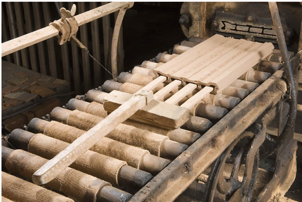
Chariot de découpe de la mouleuse-étireuse. Enlèvement d'une brique creuse.
