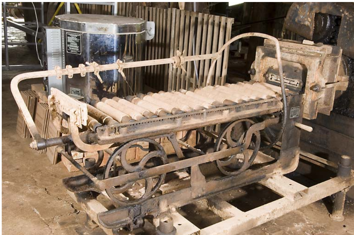
Chariot découpeur de la mouleuse-étireuse.
