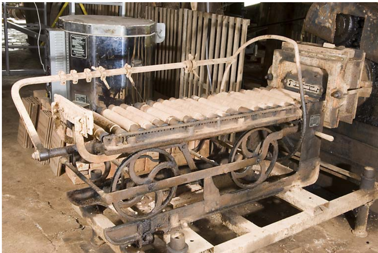
Chariot découpeur de la mouleuse-étireuse.
