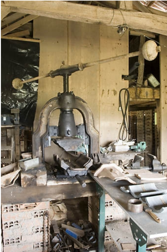
Presse à balancier (pour tuiles faîtières).
