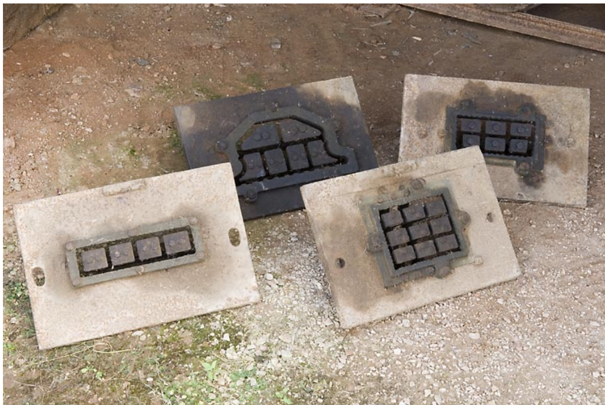
Matrices pour briques de la mouleuse-étireuse.
