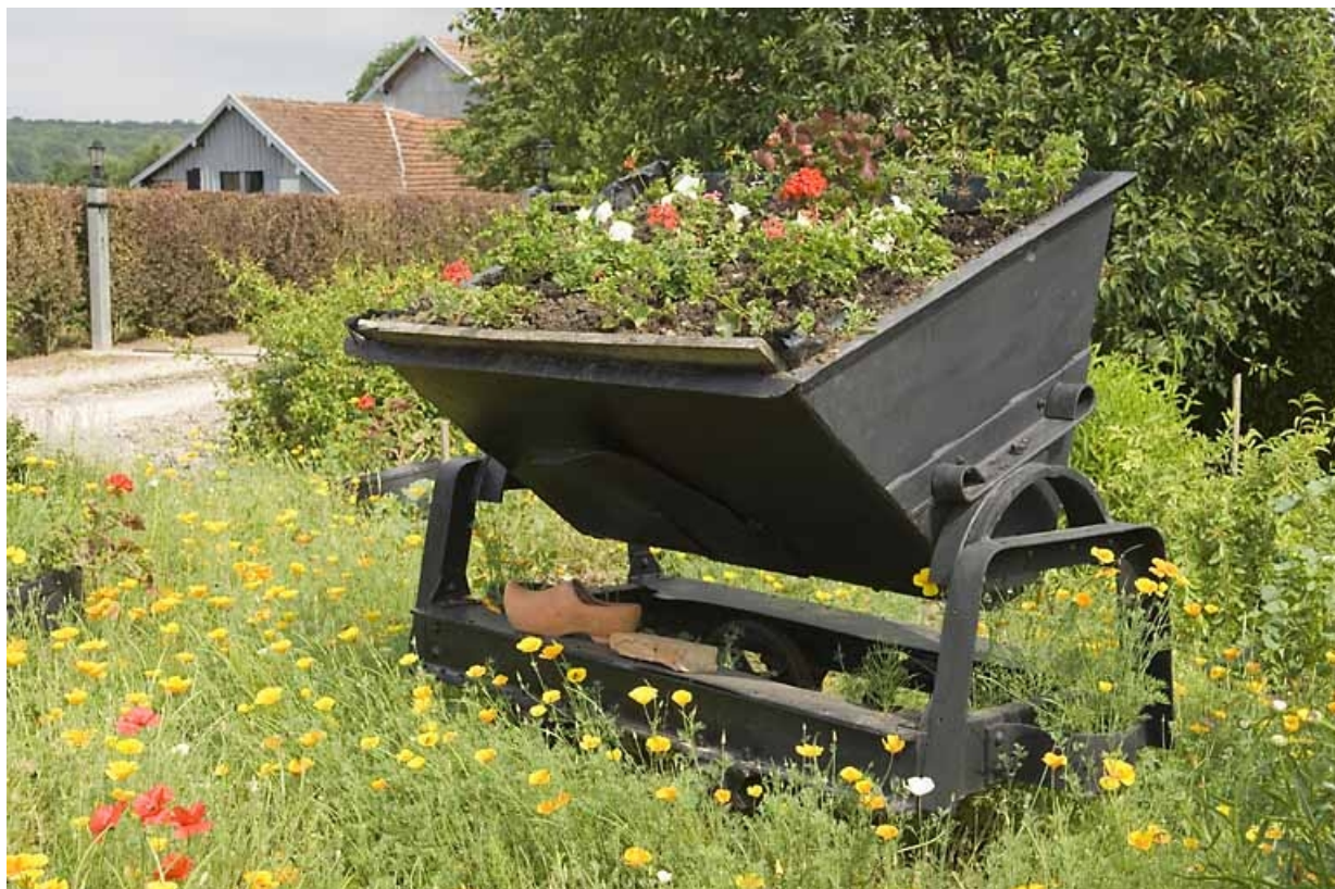
Wagonnet à bascule (transport de la terre).
