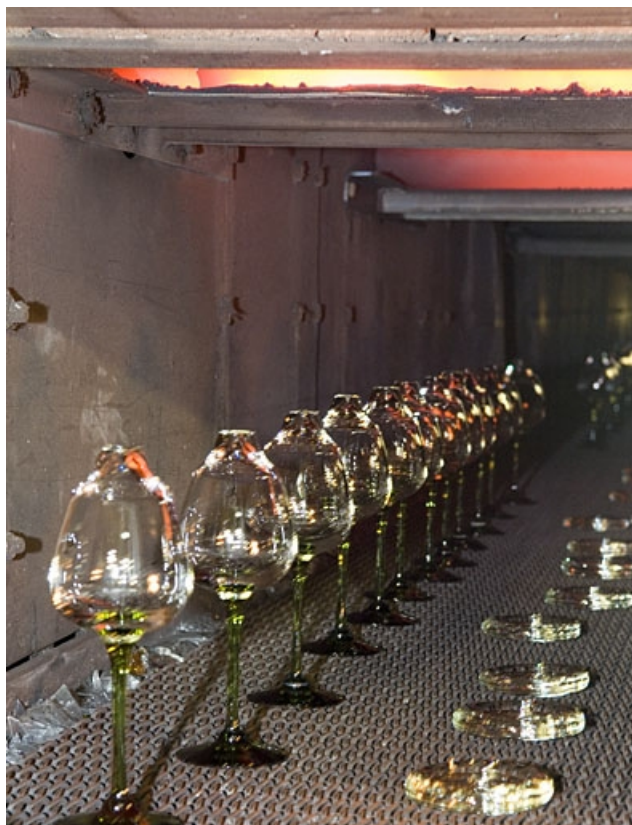
Intérieur du four à recuire (arche).
