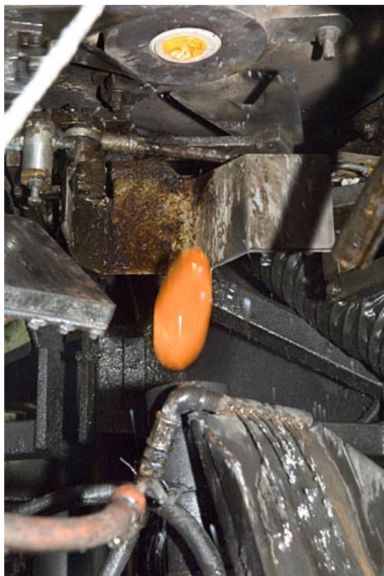
Mouleuse de tuile de verre. Chute de matière avant moulage.
