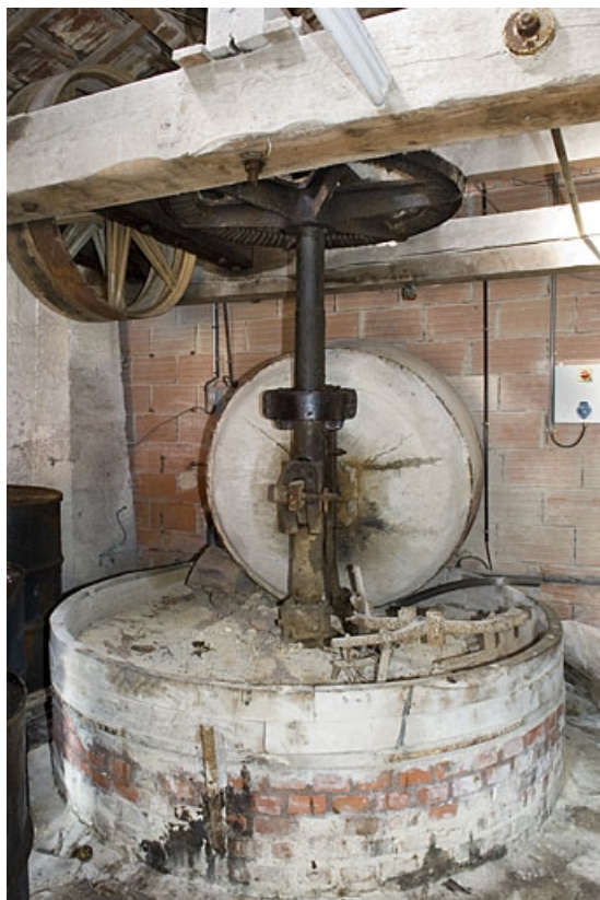
Meules de broyage de la terre (atelier dit pilerie).
