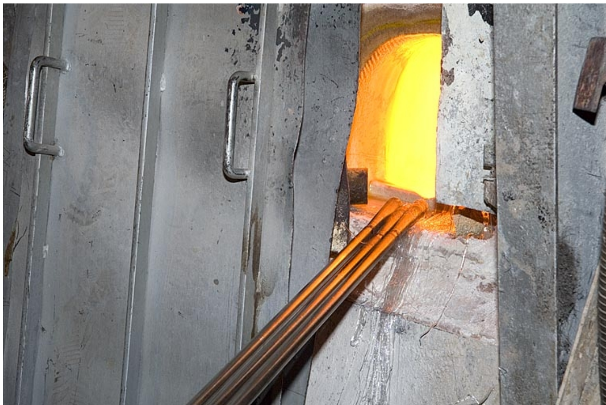
Four à pots. Canes et ouverture.
