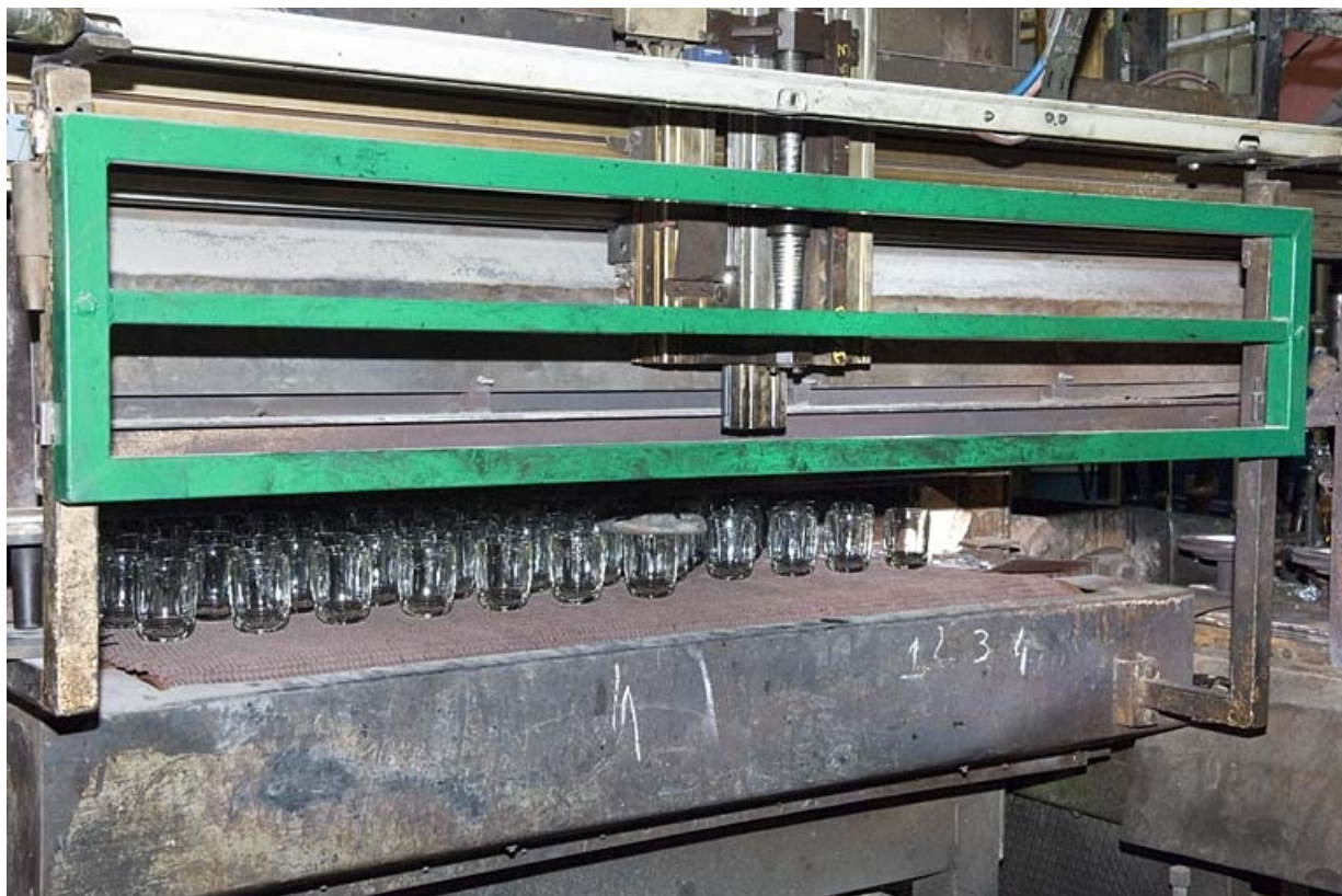
Four à recuire (atelier Articles de table).
