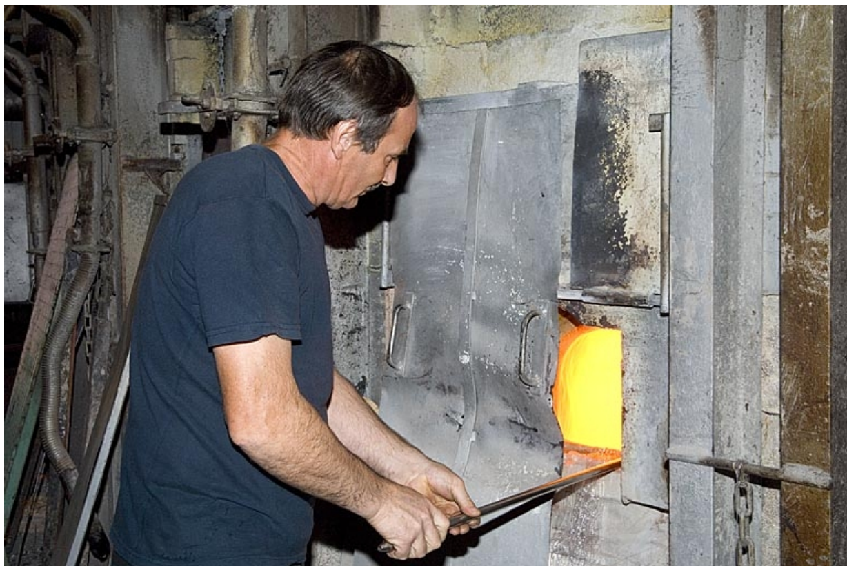
Prélèvement du verre en fusion (ou cueillage) par le cueilleur marbreur.
