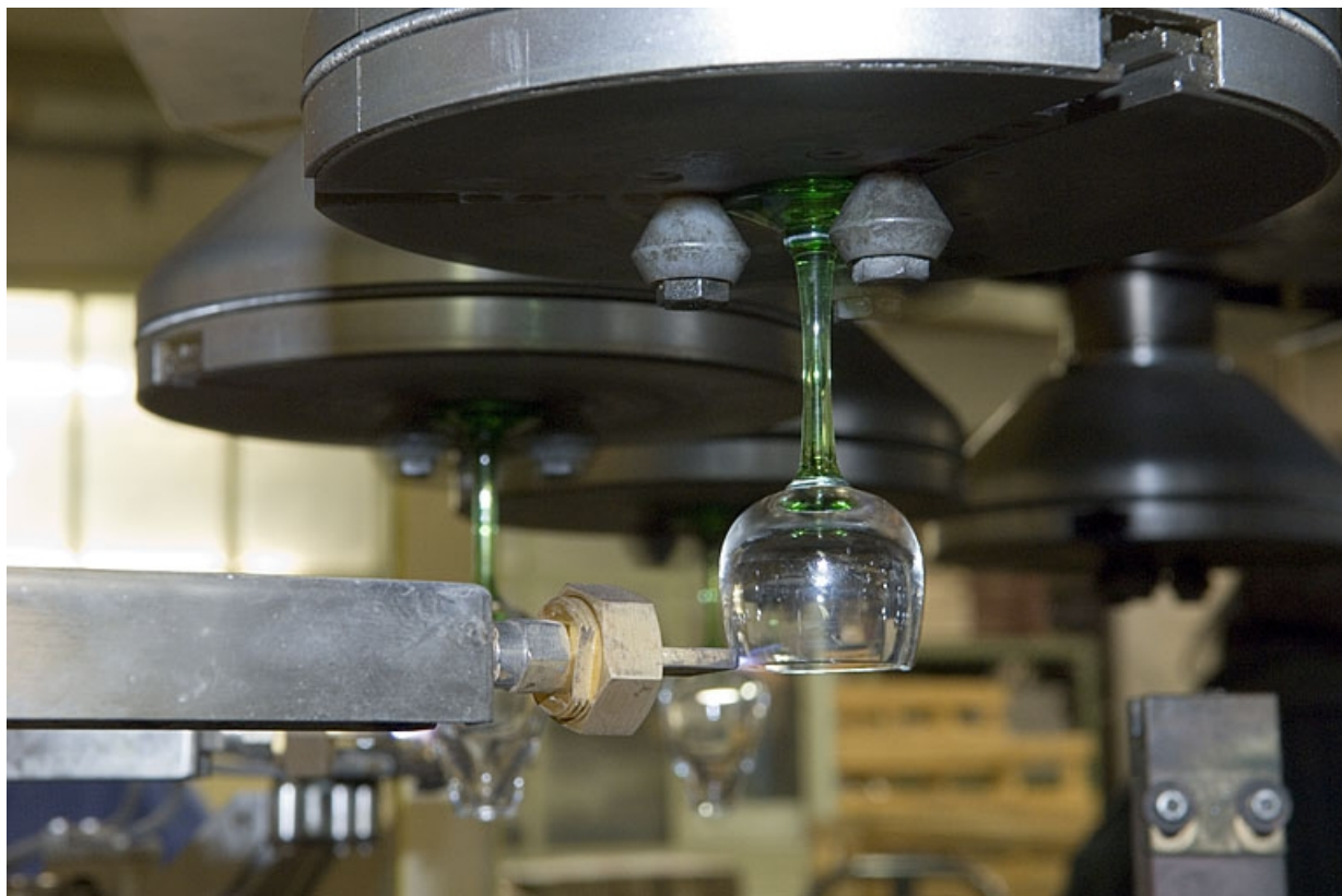
Flettage (ou rebrûlage) des bords d'un verre.
