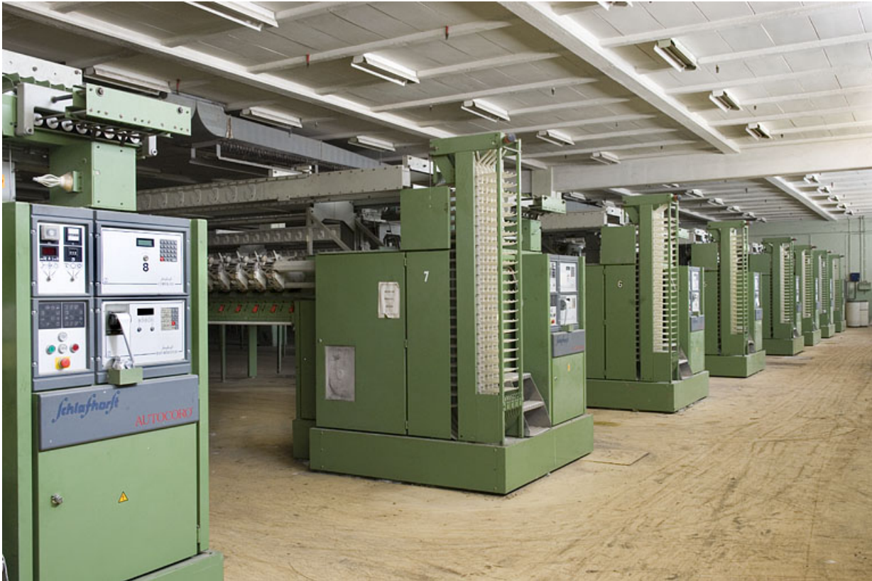
Têtes de lignes des continus à filer Autocoro.
