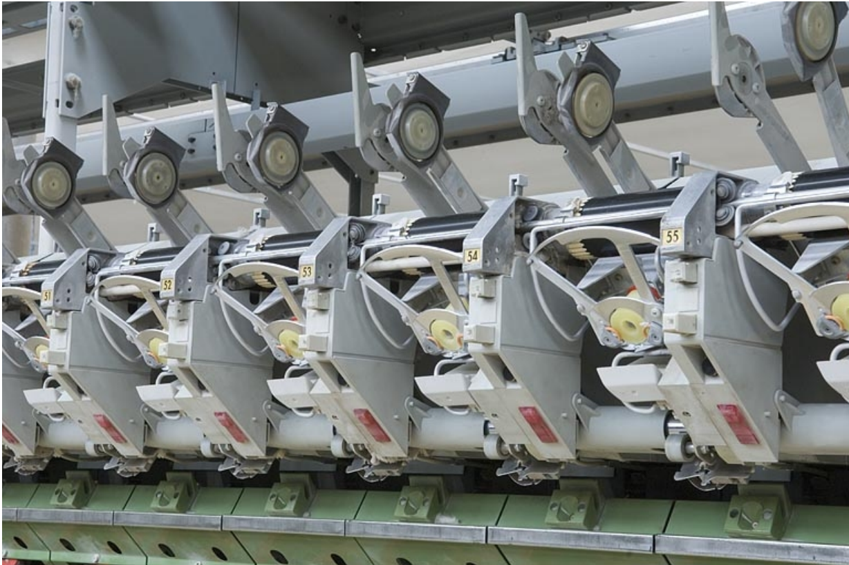
Têtes de continu à filer Autocoro.
