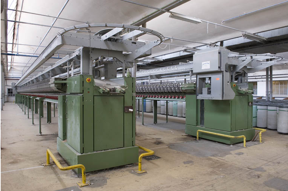
Deux lignes de continus à filer Schlafhorst, modèle Autocoro.
