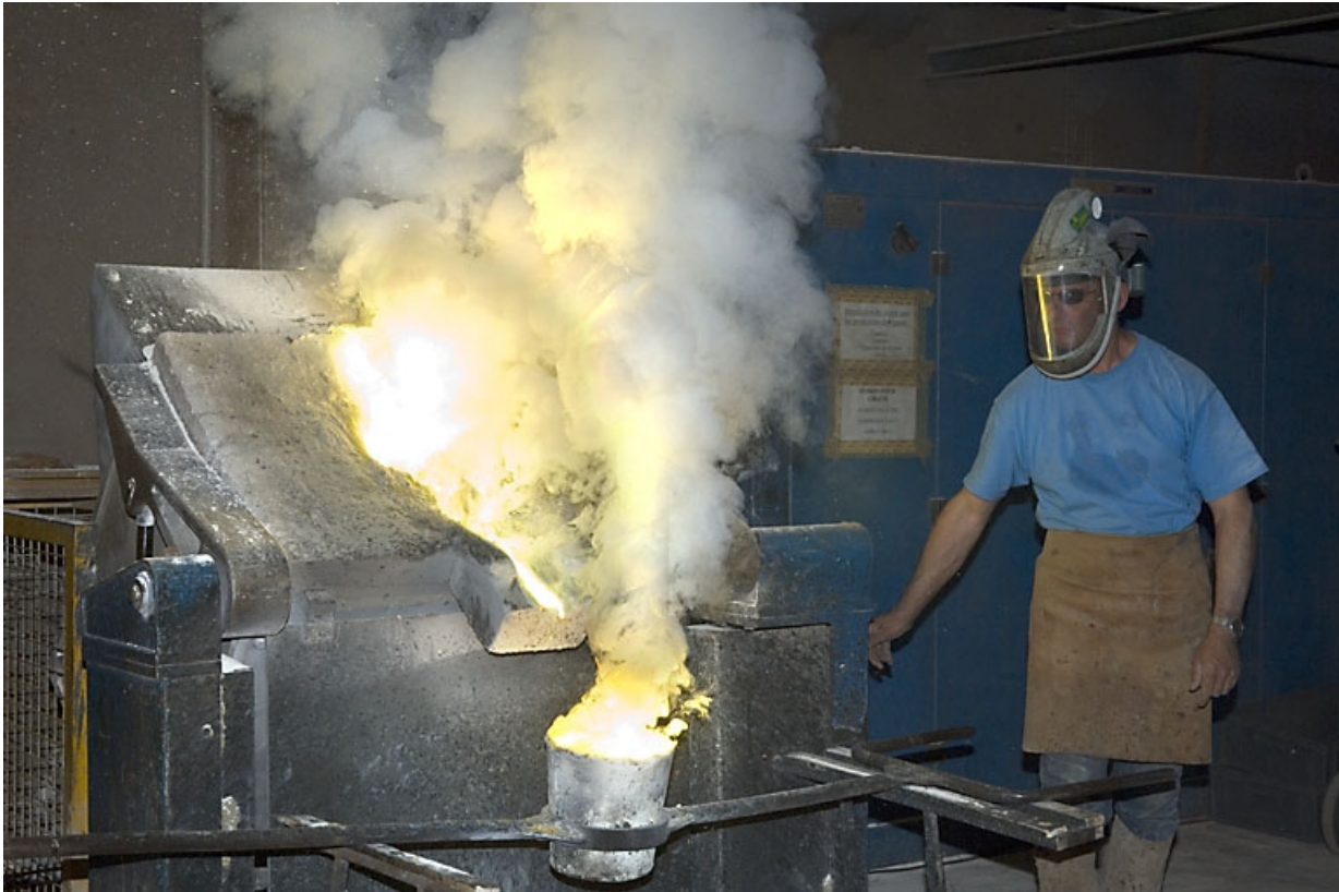
Bascule du four pour le second remplissage de la poche.
