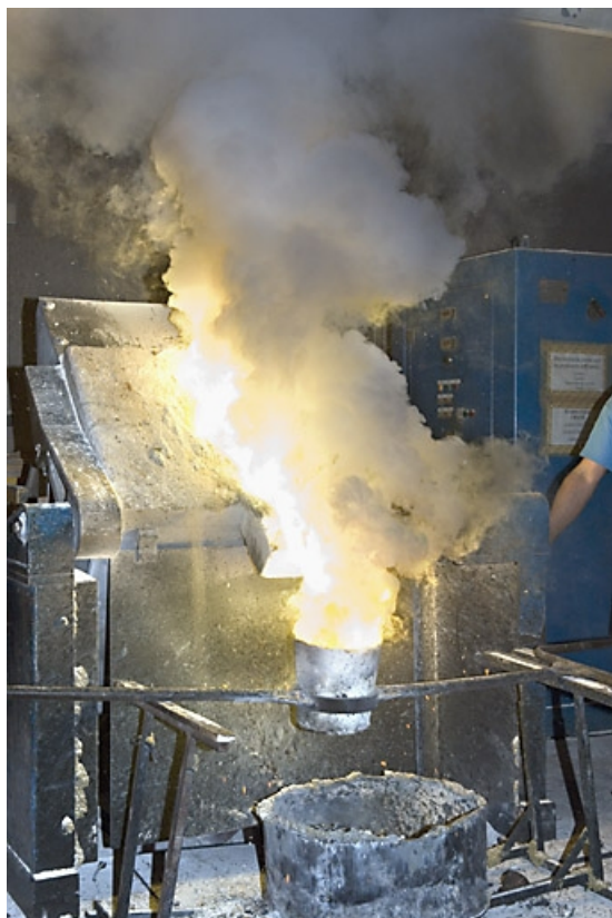
Four électrique. Remplissage de la poche (vue rapprochée).
