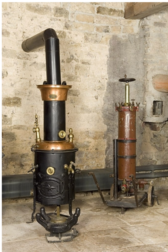
Chaudière des Ets Chatillon (pour l'entretien des tonneaux de fermentation) et filtreuse Simoneton. 70, Fougerolles, lieudit : le Petit Fahys
