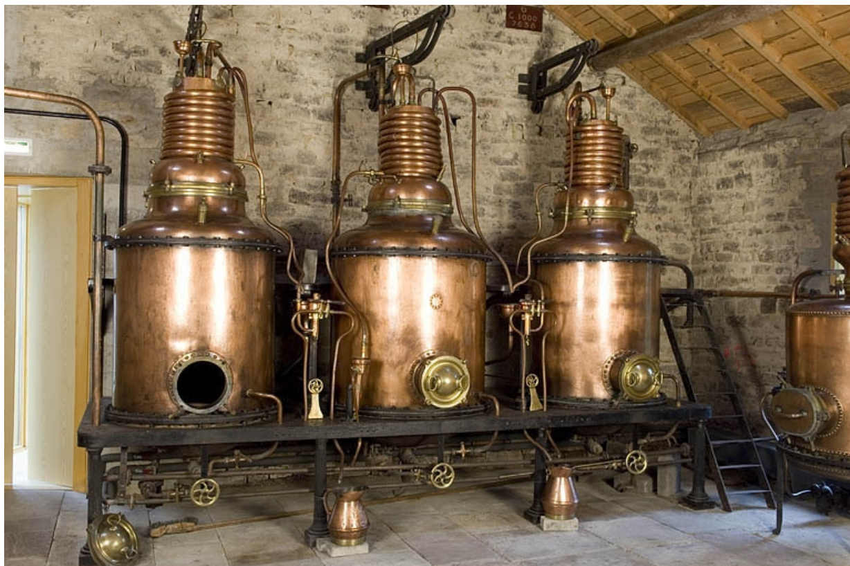
Trois alambics à vapeur (1000-1200 l) provenant de la distillerie Lemercier (Prédurupt). 70, Fougerolles, lieudit : le Petit Fahys
