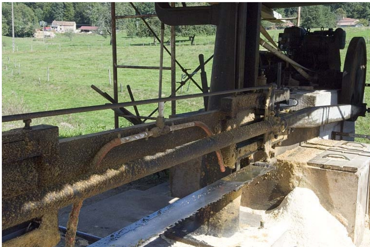
Scie horizontale monolame. Détail de lame, de la transmission (bielle et manivelle) et du moteur (hameau de la Louvière). 70, Aillevillers-et-Lyaumont, lieudit : Pont les Ports
