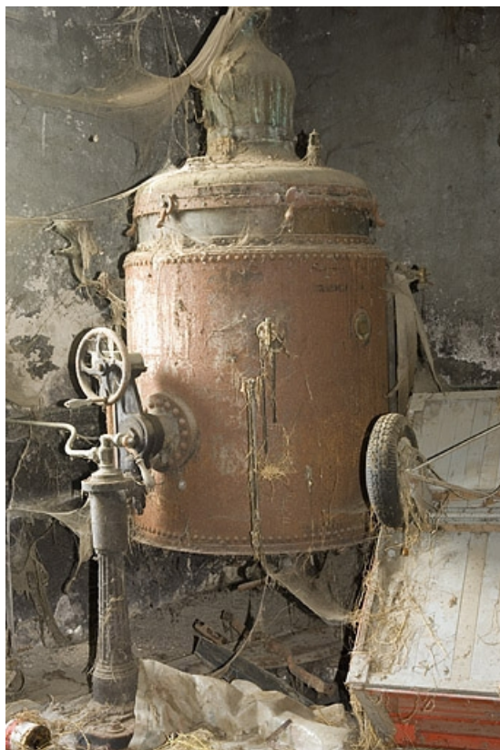
Atelier de distillation. Alambic Egrot et Grangé.
