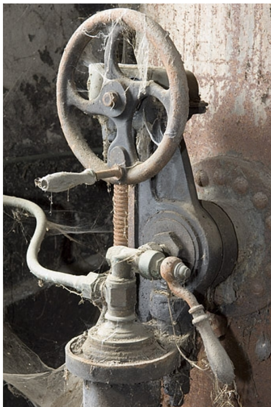
Atelier de distillation. Alambic Egrot et Grangé. Volant du mécanisme de bascule. 70, Aillevillers-et-Lyaumont, 1 rue de la Gare
