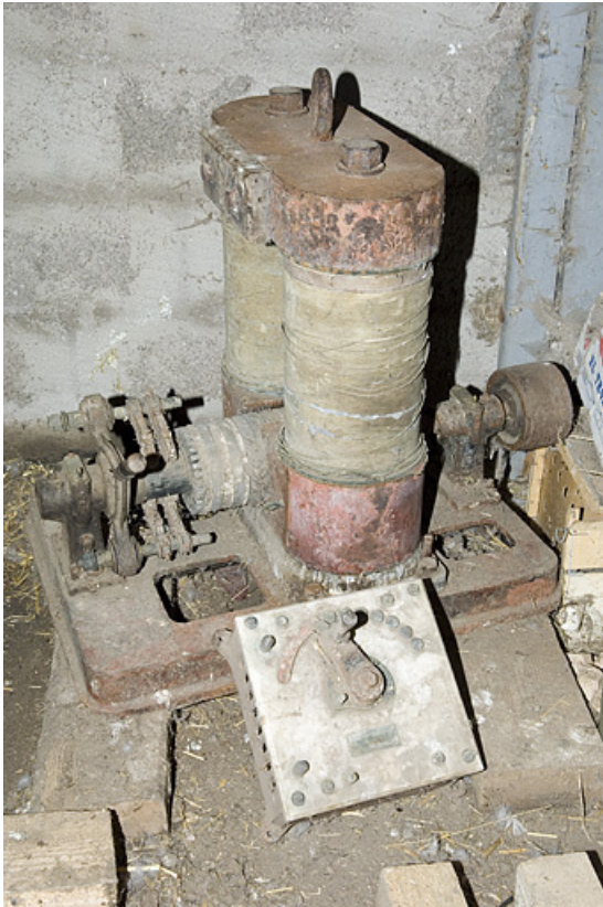
Moteur électrique Edison et tableau électrique.
