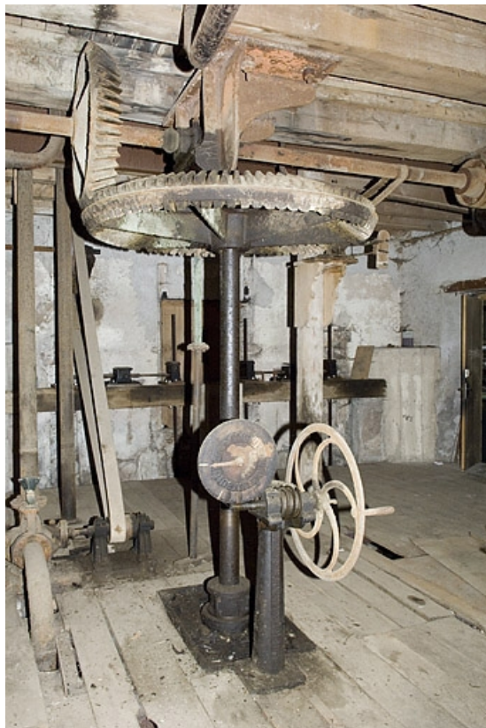
Système de transmission à l'aplomb de la turbine Goulut-Borne.
