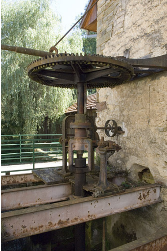
Turbine hydraulique. Partie supérieure de la transmission.
